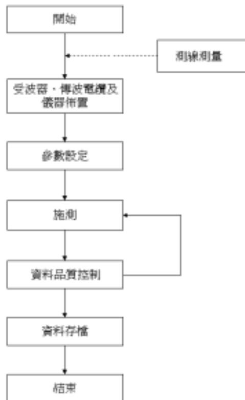
圖 3.1.2 折射震測流程圖
