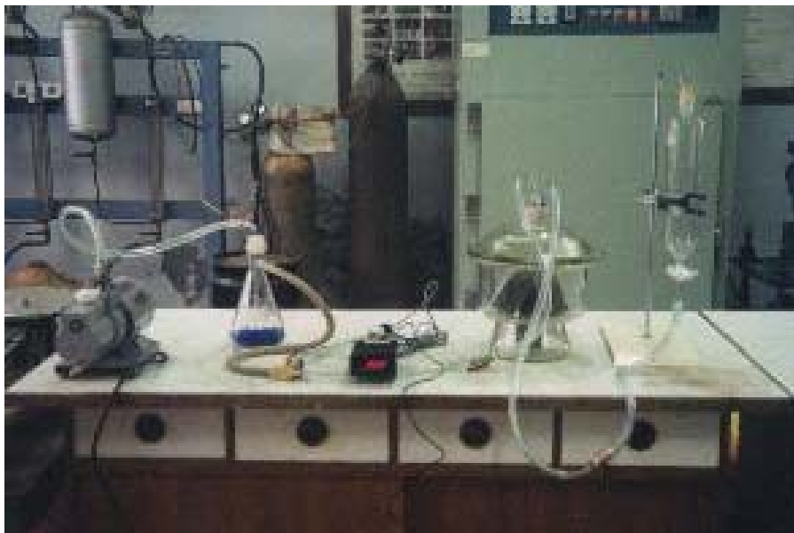
照片 5.4 電滲量試驗儀器（一）-試體前處理
