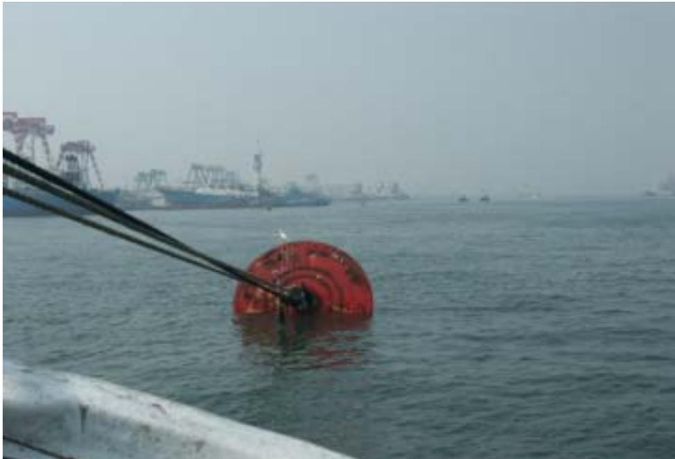
照片 3.2 在航道中央利用繫船浮筒進行剖面流場觀測
