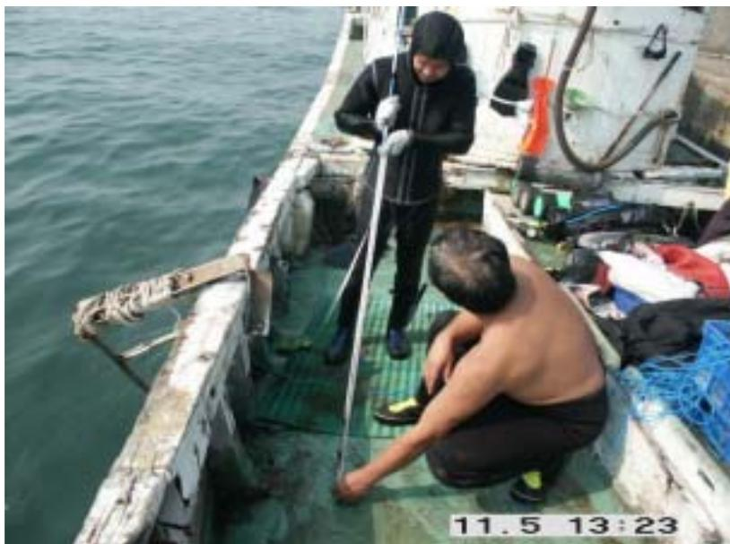
照片 4.2 潛水人員探測完成後以米尺量取探棒之測泥厚度
