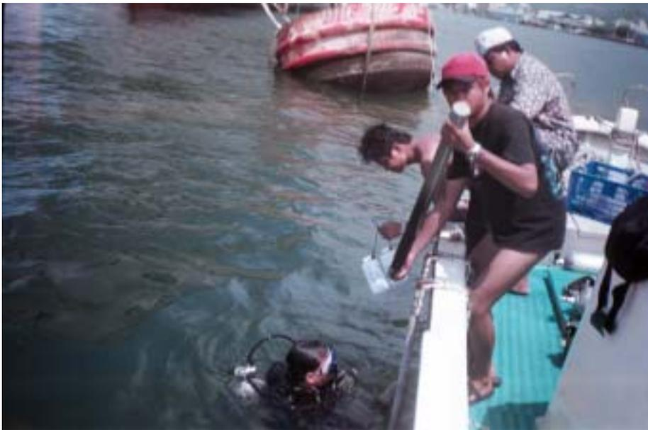
照片 4.4 潛水人員以壓克力管鑽採底泥情形(b)
