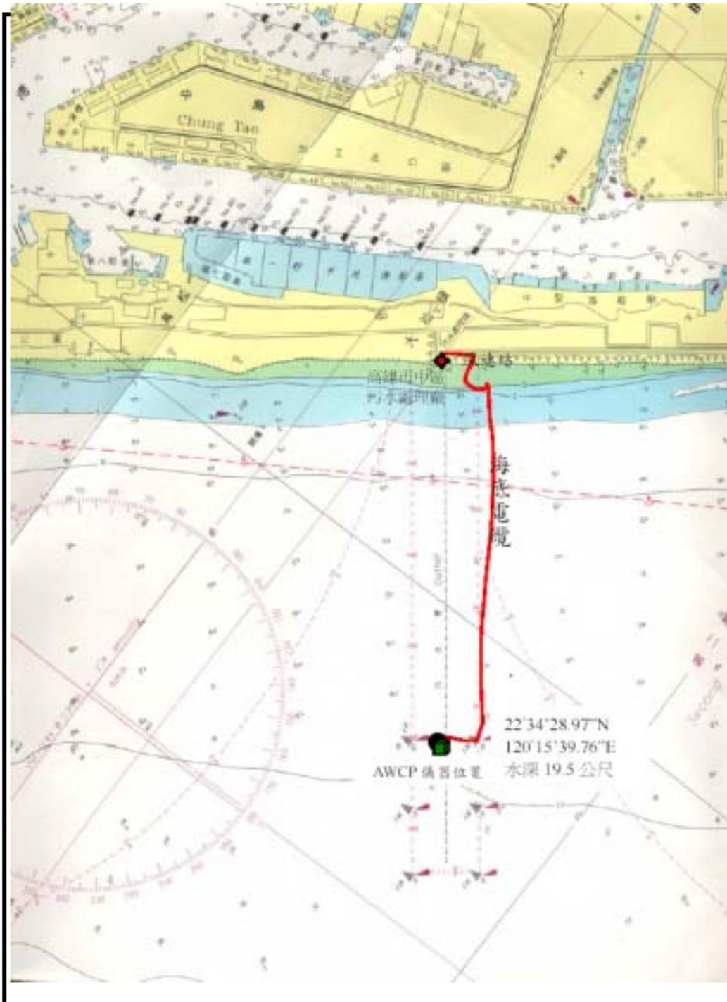
圖 5.1 高雄港海氣象觀測站儀器安裝佈置示意圖
