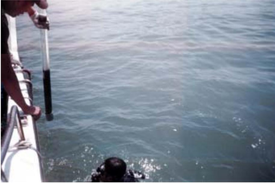
照片 4.3 潛水人員以壓克力管鑽採底泥情形(a)
