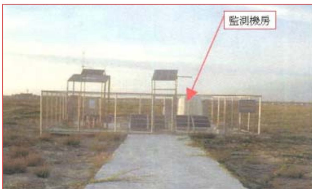
照片 7-1 布袋港地震及動態孔隙水壓監測站
