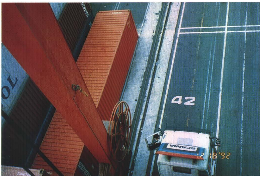
圖3.24 門架式起重機之天線讀取拖車車頂上電子卡資料
