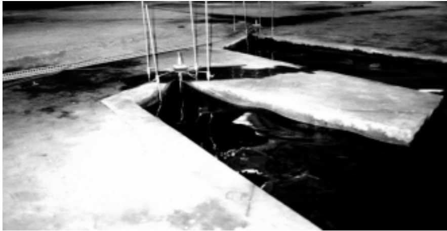
圖二十 簡(1997)的實驗中內港的共振現象
