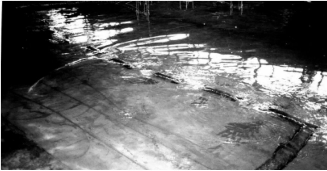
圖三 花蓮港模型試驗(由花蓮港南方海岸朝港口方向拍攝)顯示港口南邊外側的波動集中於海岸附近，類似由南向北傳的邊緣波
