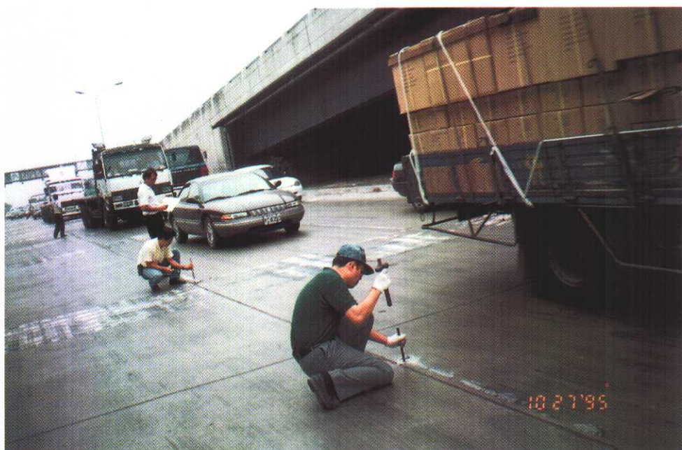
照片 15 埋設試驗半年後之挖取(地點：中山高速公路高雄端出口)
