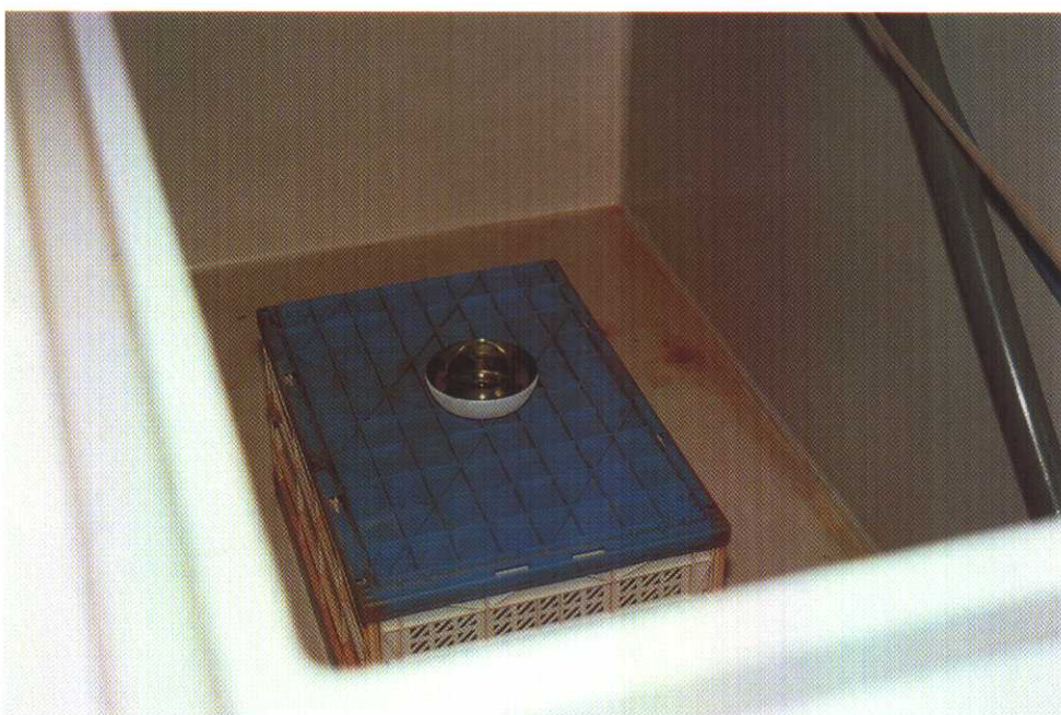
照片 24 鹽霧試驗機之標記擺設(ARTC 提供)
