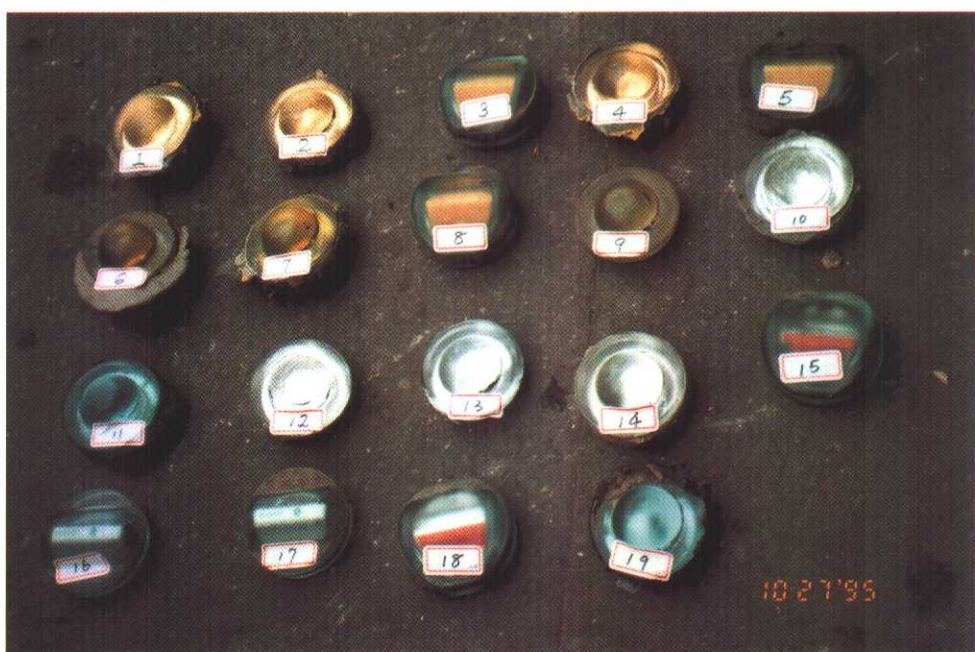
照片 16 埋設試驗半年後挖取之標記
