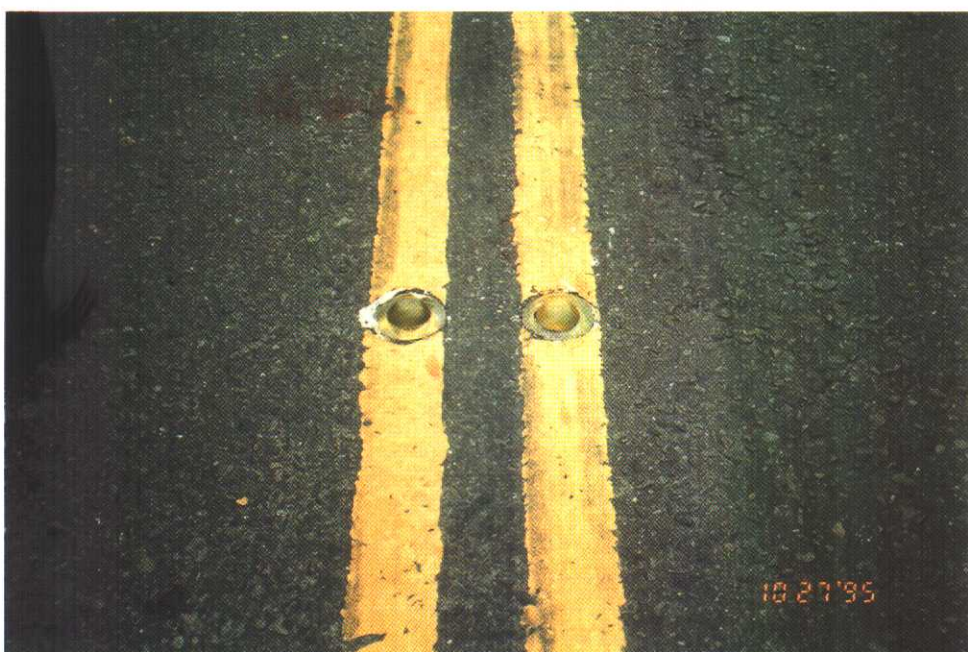
照片 14 埋設試驗半年後之標記正常狀況(地點：高雄市新生路)
