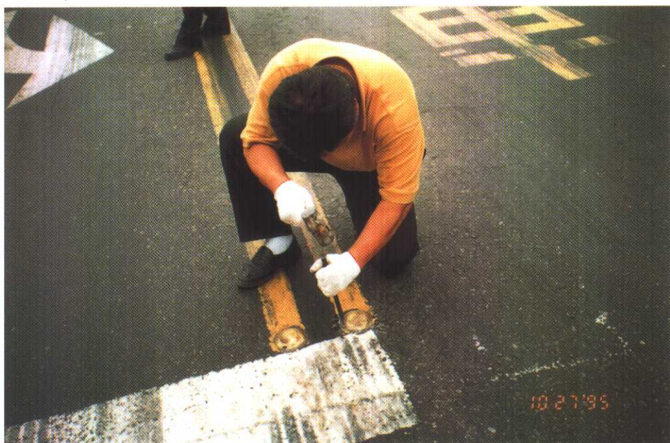
照片 13 埋設試驗半年後之標記挖取作業(地點：高雄市新生路)
