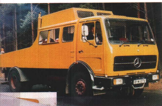
照片十八 TRL 落錘撓度計
