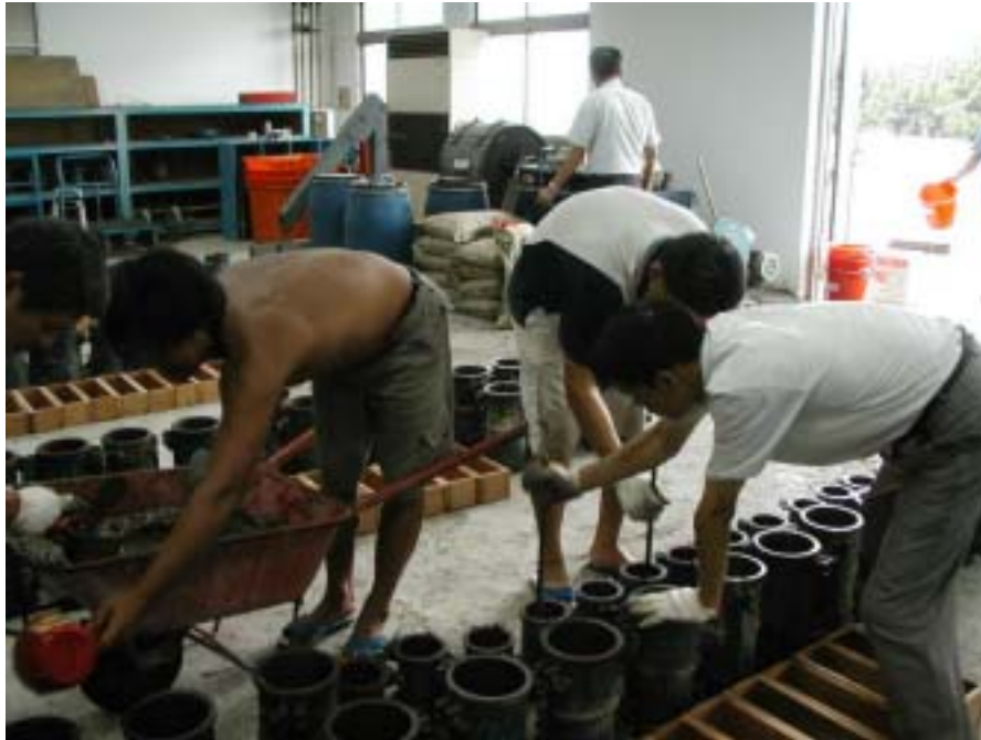
照片 4.3 試體灌製情形
