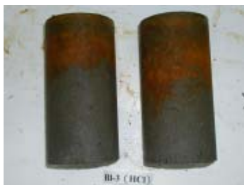
照片 4.27 配比 A 及 B 浸泡 HCl 後之情形
