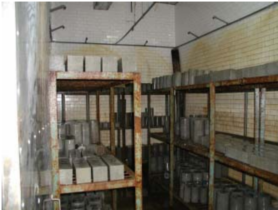
照片 4.4 混凝土養生室養護
