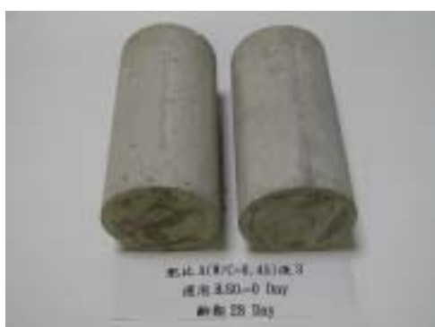
浸泡前 浸泡後 照片 4.24 配比 A 浸泡 H_2SO_4 前後之情形
