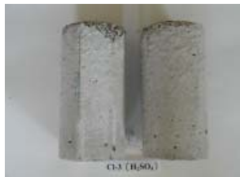
浸泡前 浸泡後 照片 4.26 配比 C 浸泡 \text{H}_2\text{SO}_4 前後之情形
