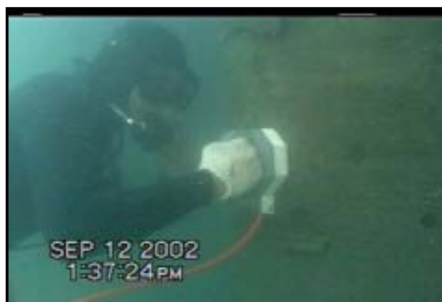
圖 3.5 水面下渦電流量測鋼板樁厚度之情形
