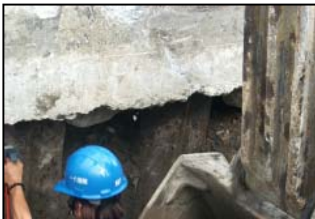
圖3.28 花蓮港鋼板樁陸側檢測情形 （渦電流法）
