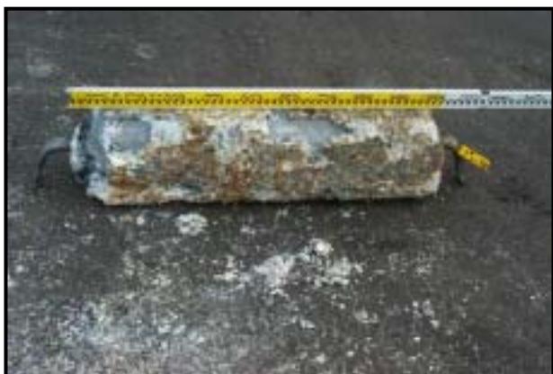
圖 3.69 基隆港陽極塊現場作業及切割後置於陸上之情形（1）
