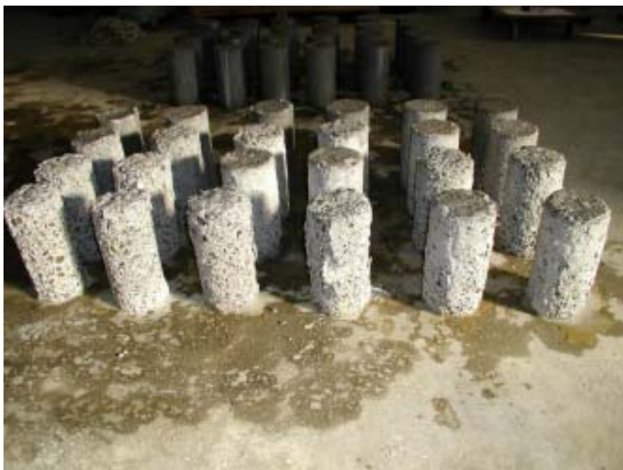
照片 4.30 試體浸泡 \text{H}_2\text{SO}_4 後之乳白色溶液
