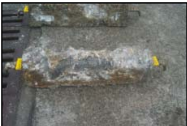
圖 3.70 基隆港陽極塊現場作業及切割後置於陸上之情形（2）
