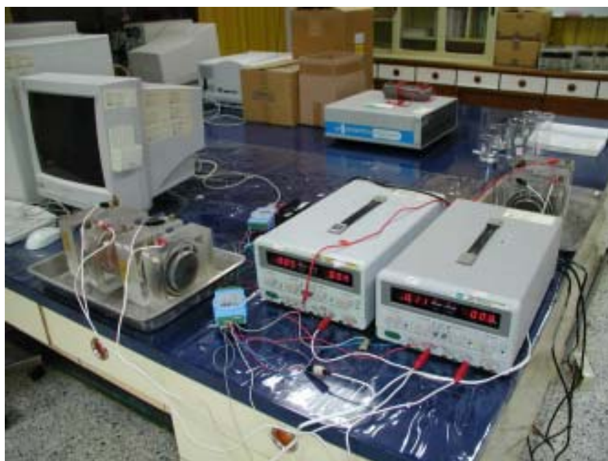
照片 4.10 電滲量試驗儀器（二）-量測電流量
