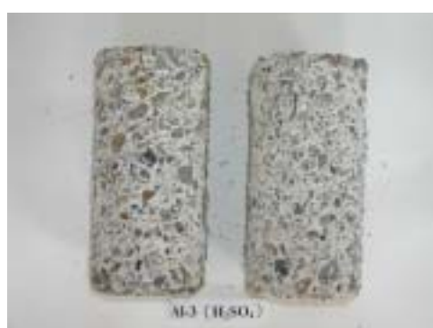
浸泡前 浸泡後 照片 4.24 配比 A 浸泡 H_2SO_4 前後之情形
