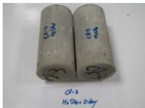
浸泡前 浸泡後 照片 4.26 配比 C 浸泡 \text{H}_2\text{SO}_4 前後之情形
