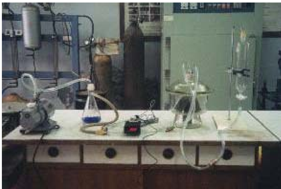
照片 4.9 電滲量試驗儀器（一）-試體前處理
