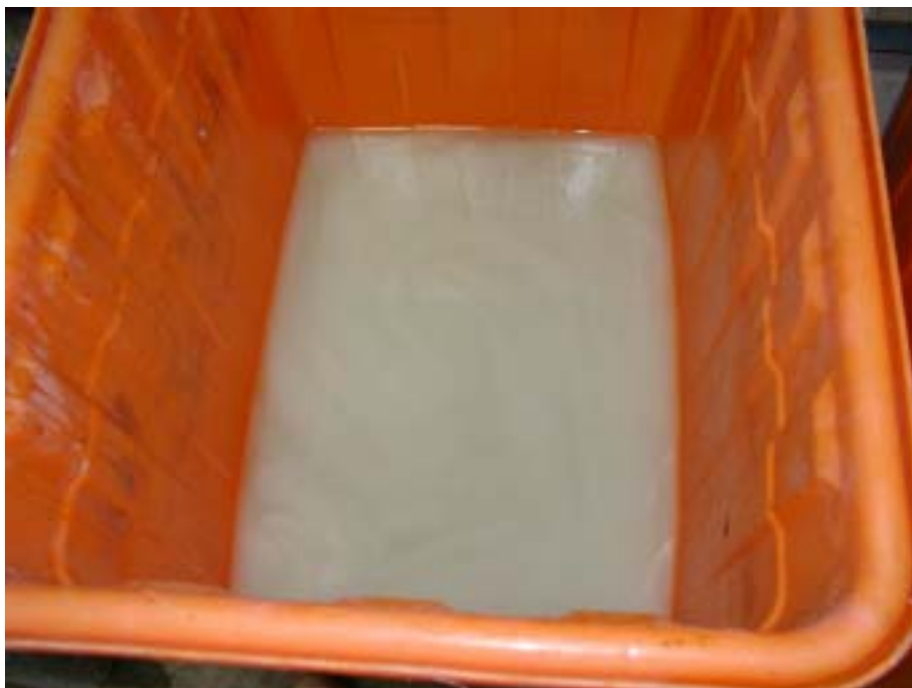
照片 4.30 試體浸泡 \text{H}_2\text{SO}_4 後之乳白色溶液
