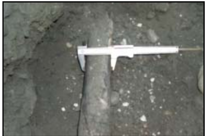
圖3.44 花蓮港航道岸壁後方10 m處拉桿厚度量測
