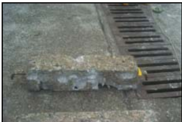
圖 3.70 基隆港陽極塊現場作業及切割後置於陸上之情形（2）
