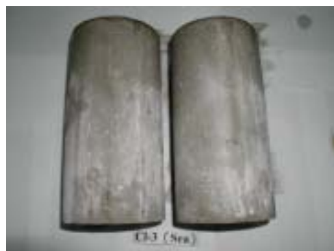
配比 B 照片 4.29 配比 B 及 C 浸泡海水後之情形 配比 C
