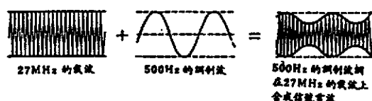
圖 3-2 載波和調制波的動作 [11]
