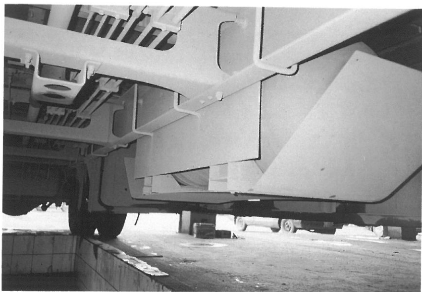
圖 4-2 大有巴士改裝車底盤高壓儲存氣瓶(一)
