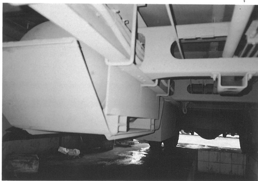
圖 4-3 大有巴士改裝車底盤高壓儲存氣瓶(二)
