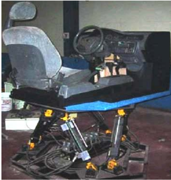
圖 2.5 六軸動態駕駛模擬器
