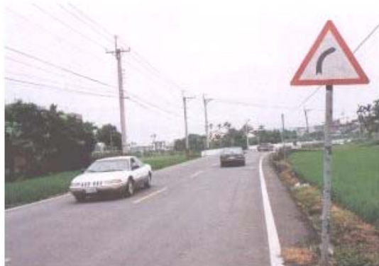
圖 7.1-7 彎道標誌設置範例
