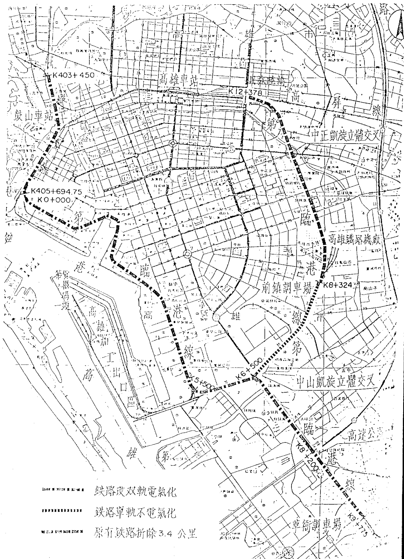
圖2-19 高雄市區臨港線東段鐵路部份拆除方案 (中華顧問工程司乙-1案)
