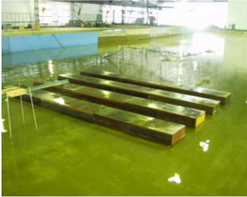
照片 4-5 試驗室潛堤及波高計配置情形
