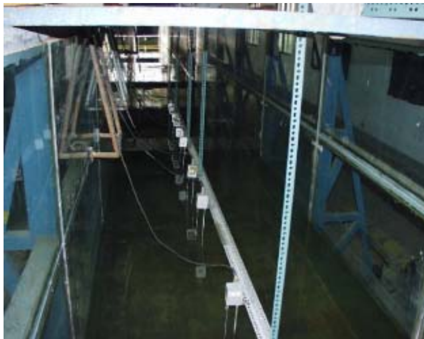
照片 4-2 潛堤前方波高計佈置
