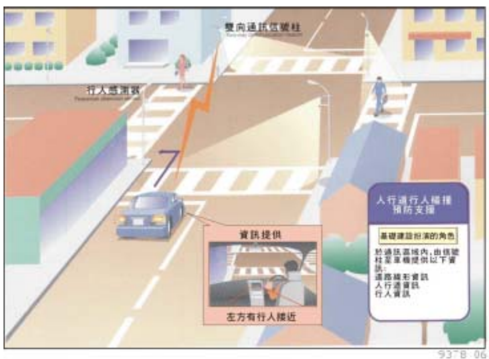
圖 3.3-15 防止碰撞行人警示系統運作示意圖
