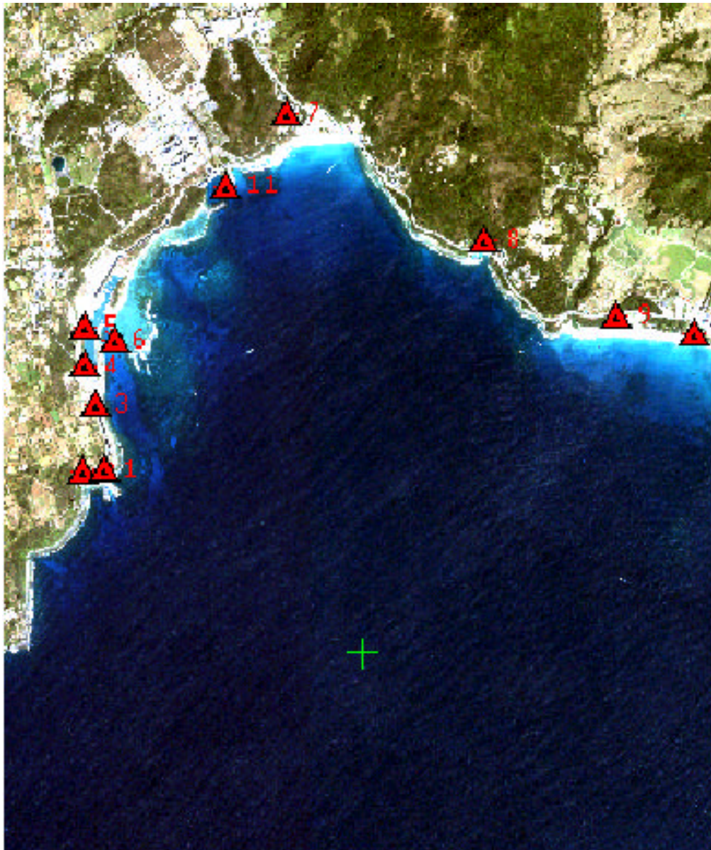
圖 6-4 平面仿射轉換所採用之平面控制點分佈示意圖
