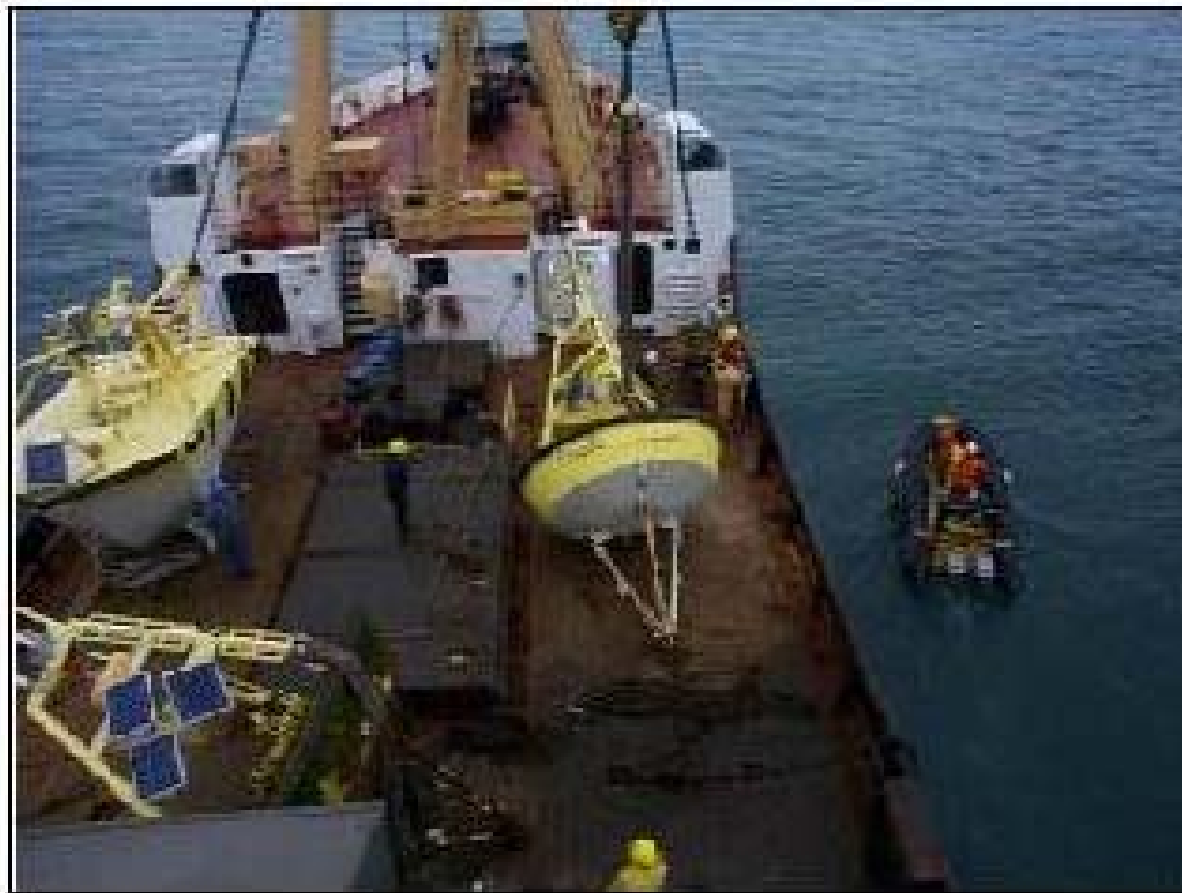
圖 2.12 BUOY 浮標平台施工、作業之情形（一）
