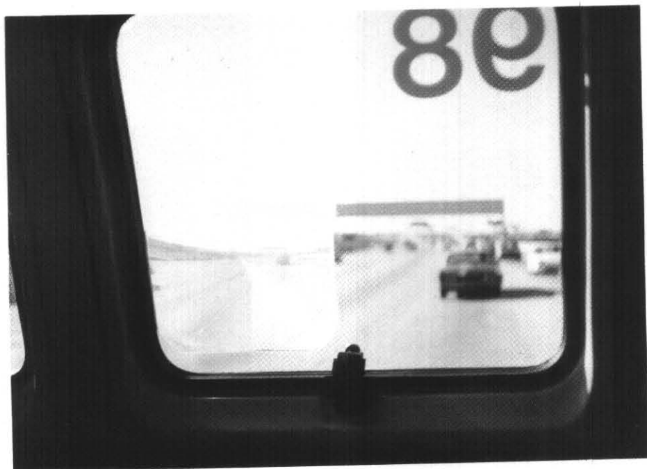
照片22. 計程車後玻璃附裝特殊透鏡
