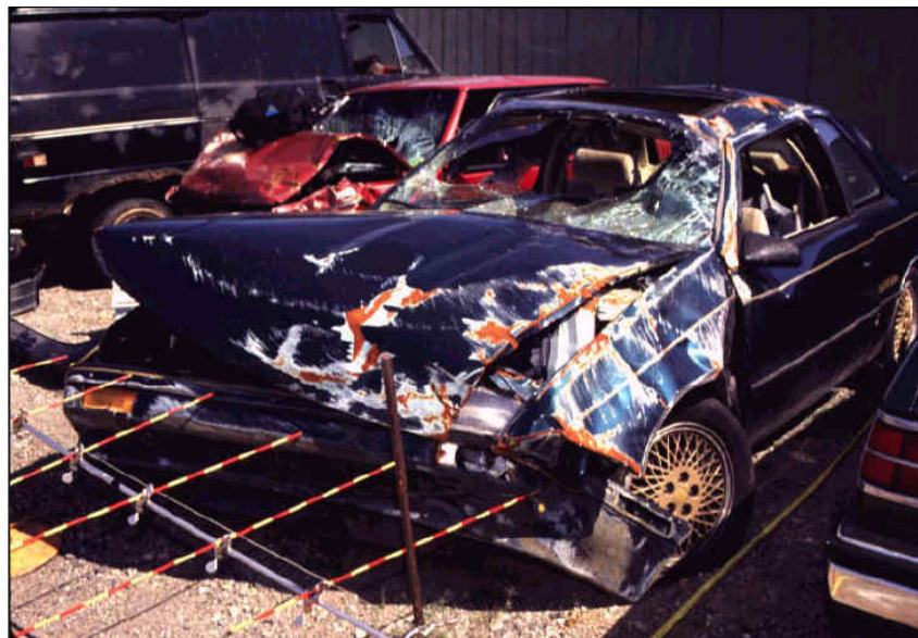
圖 5-5 使用輔助器材來量測車子變形的程度照片
