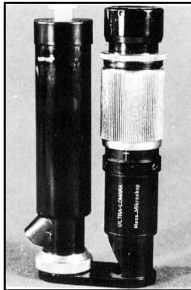
圖 2.2 Pentex ASAHI 裂縫測微計（資料來源：參考文獻 48）
