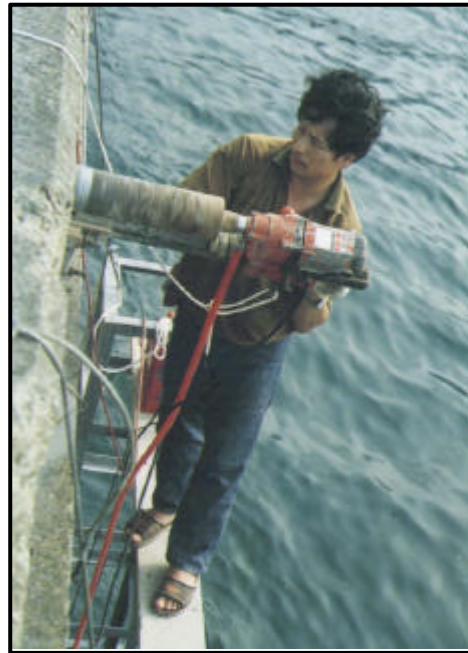
圖 2.12 可攜帶型混凝土鑽心取樣機
