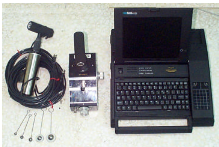
圖 2.19 敲擊回音儀
