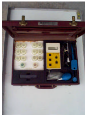
圖 2.34 快速氯離子測定儀
