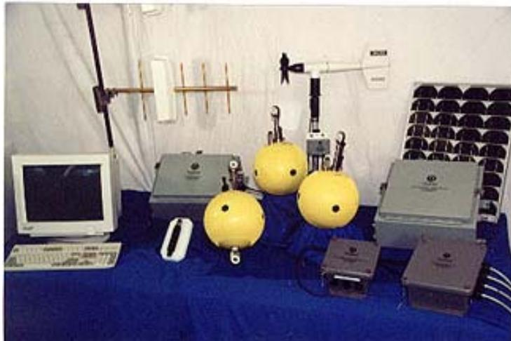
圖 5.1 安平海氣象觀測儀器及配置
