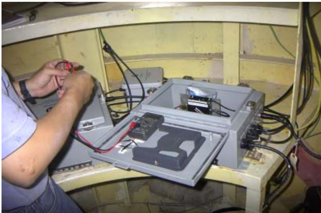
圖 3.3 安平觀測樁儀器系統維護與保養工作
