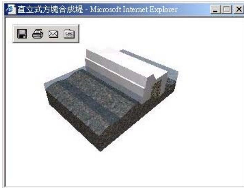
圖 14-68b 直立式方塊合成堤堤防立體圖
