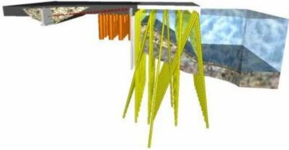
圖 14-38c 鋼筋混凝土樁棧橋式碼頭立體圖
