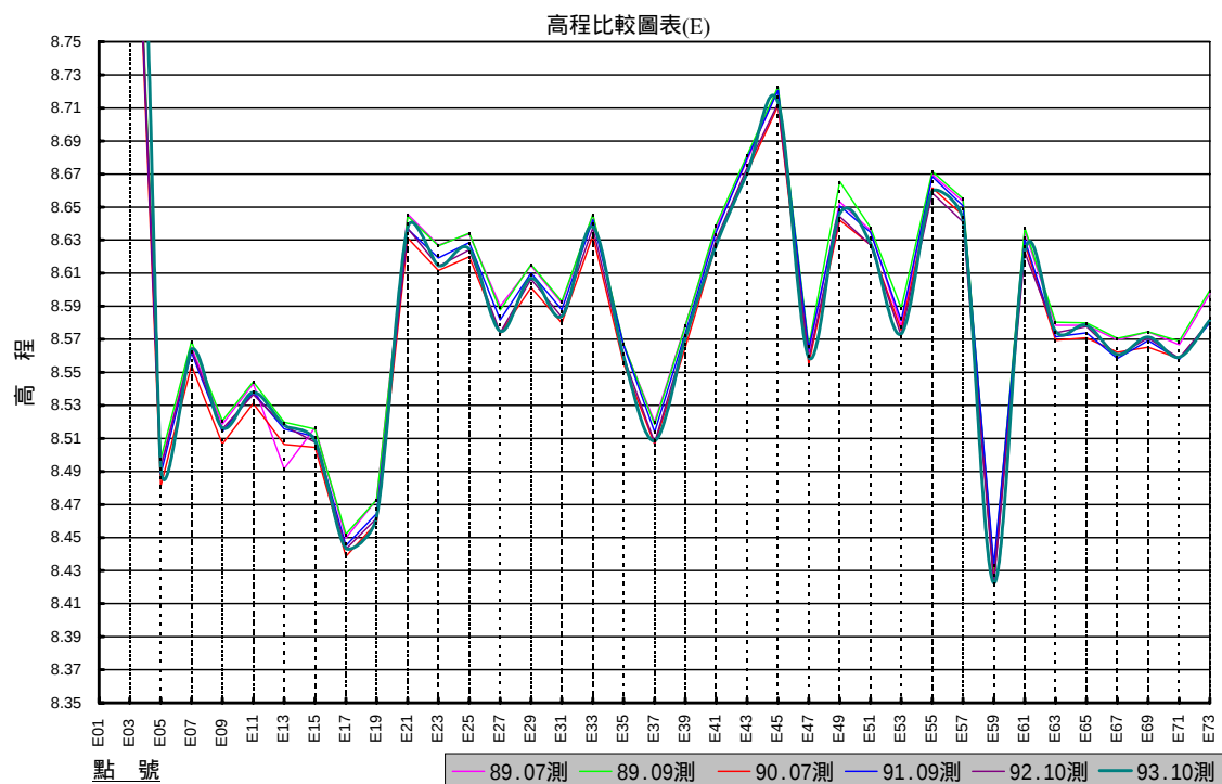
圖 5.23 花蓮港東堤高程測量各 E 點之歷年逐次比較圖
