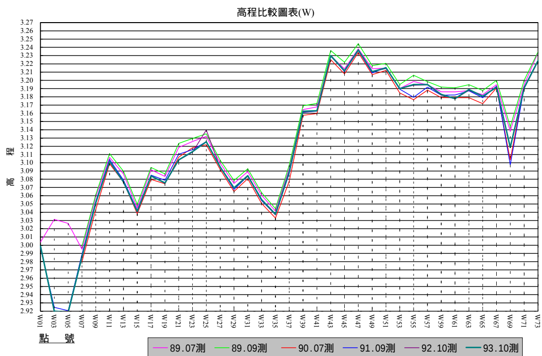
圖 5.26 花蓮港東堤高程測量各 W 點之歷年逐次比較圖
