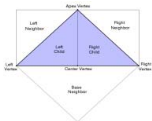
圖 3.16 基本鑽石型三角 二元樹結構分割
