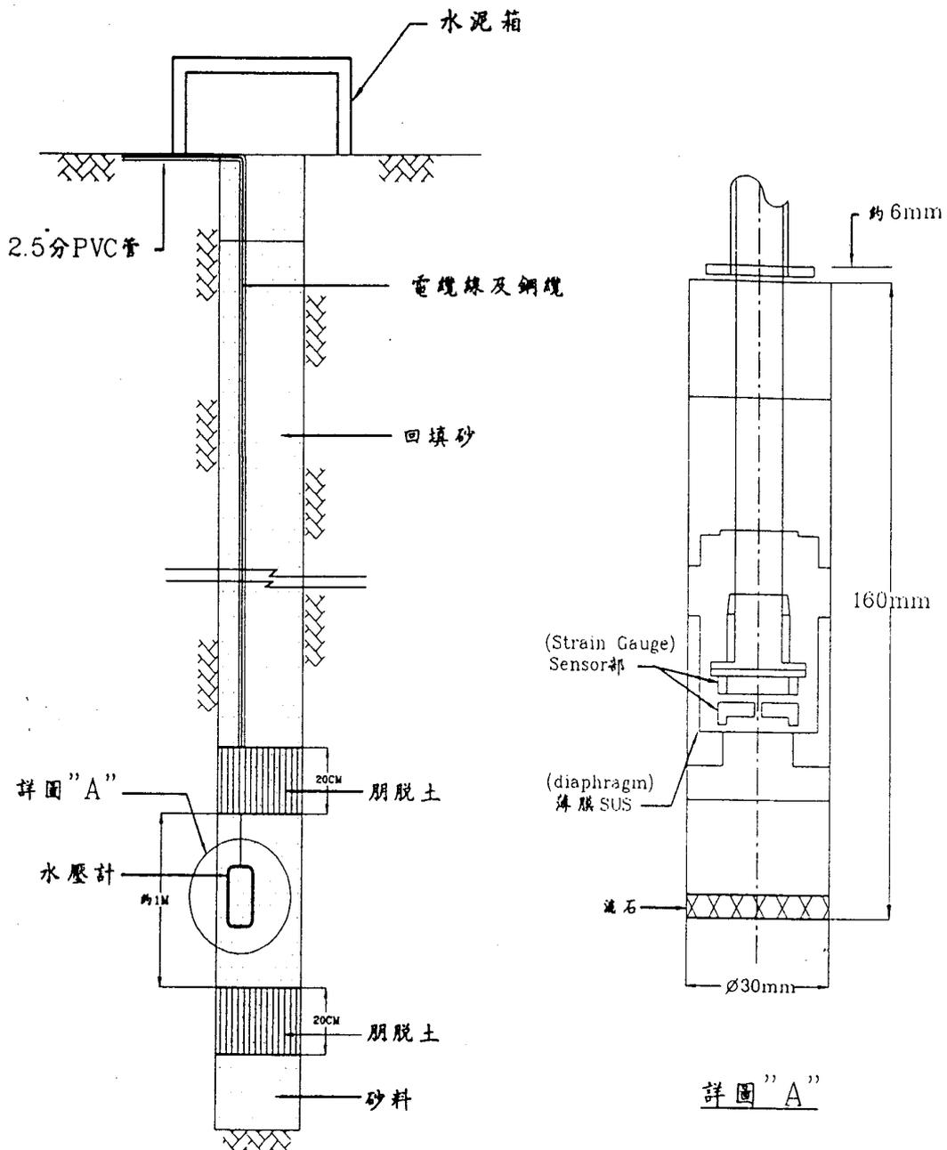
圖 3-2 電子式地下水壓計安裝示意圖
