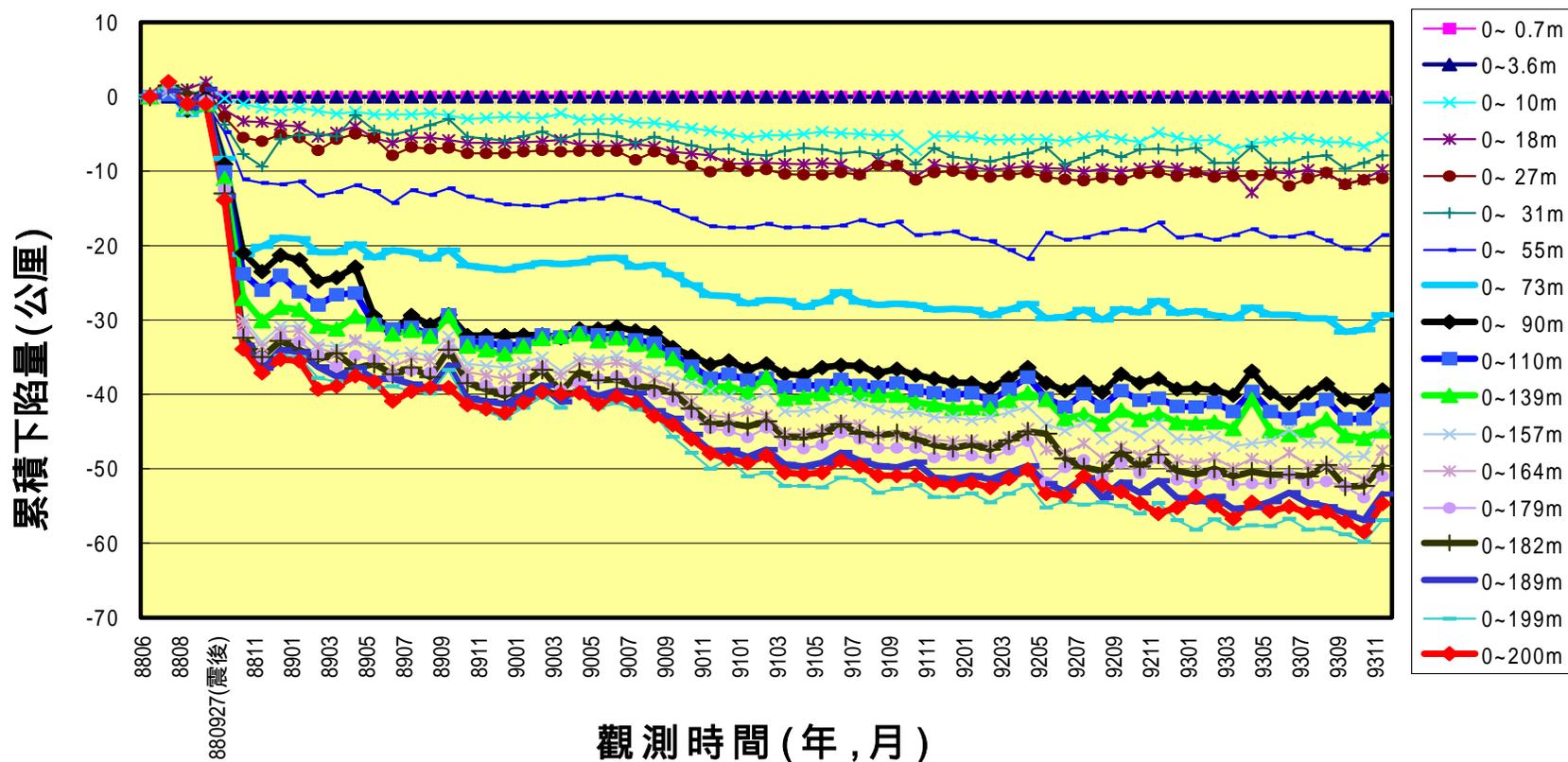
圖 4-18 臺中港分層累積下陷量圖(200m)
