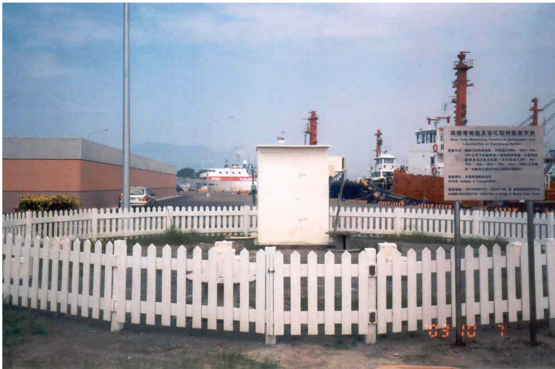
照片 高雄港地震、液化監測站
