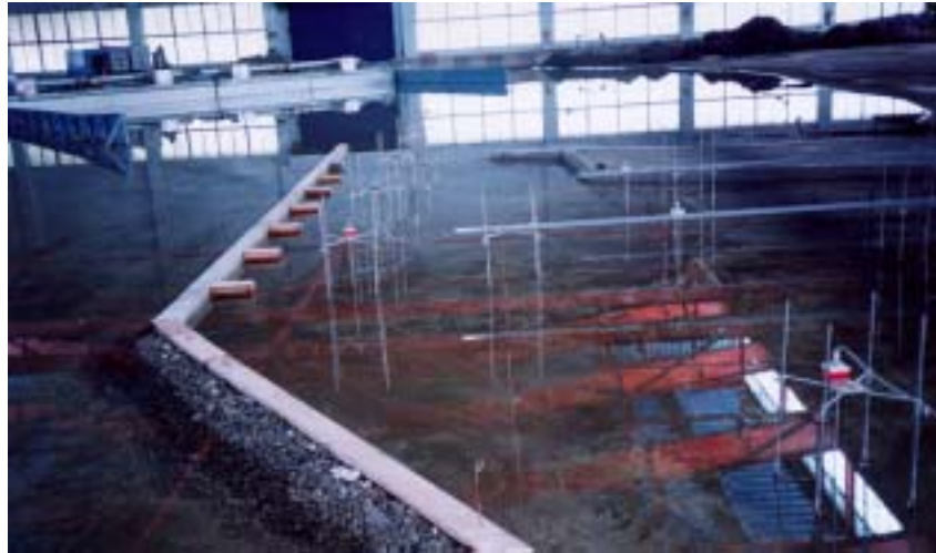
照片 3-5 東防波堤港側佈置一系列短突堤以消減長浪
