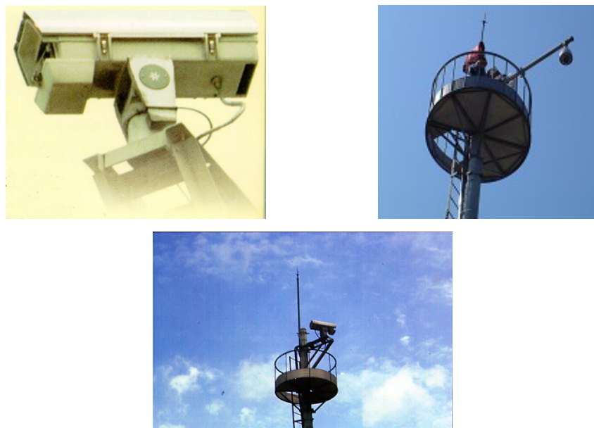
圖 3.1.3-2 閉路電視監視器—裝設於交流道、收費站、豪雨區及事件偵測器等重要據點
