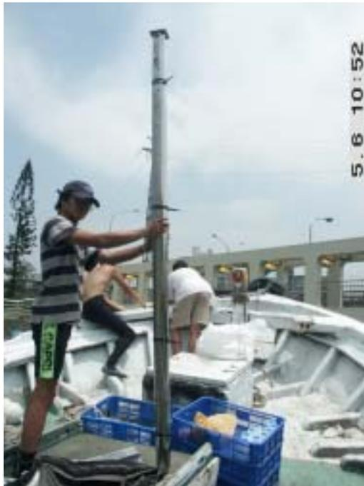
照片 3.13 底質鑽採用不鏽鋼底泥鑽管
