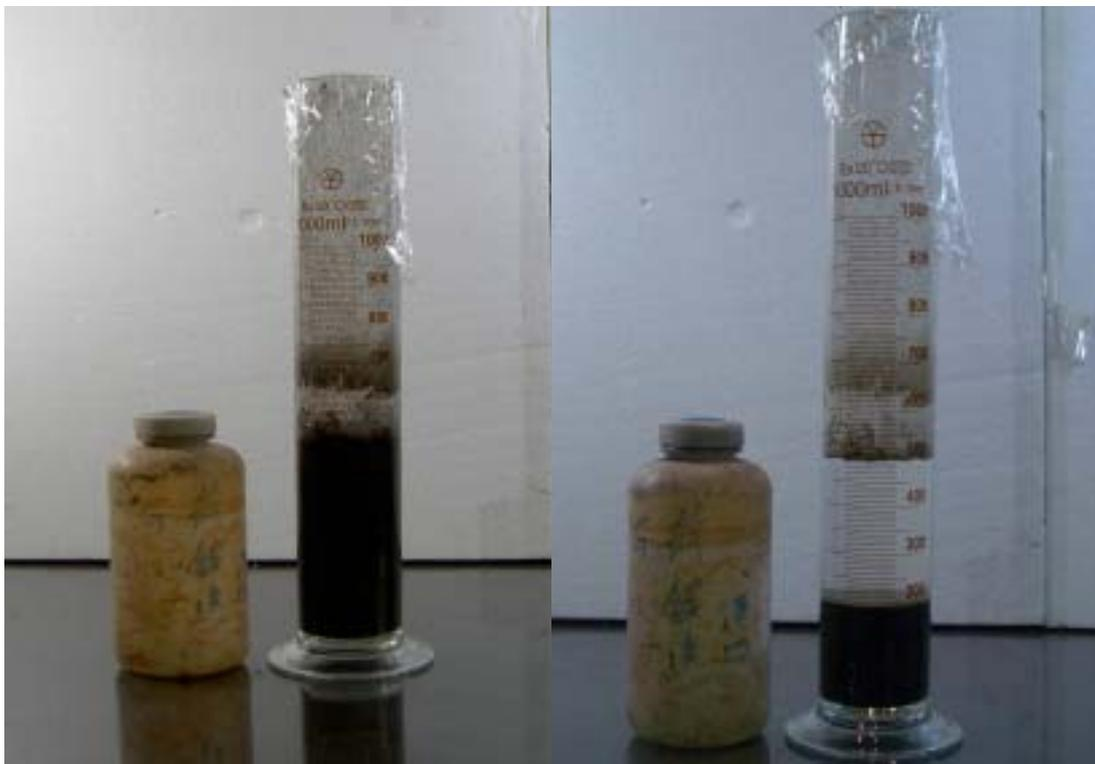
圖 7.15 G.前鎮漁港口沈降實驗界面變化
