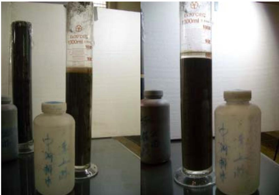
圖 7.23 中鋼排水溝上游沉降實驗界面變化
