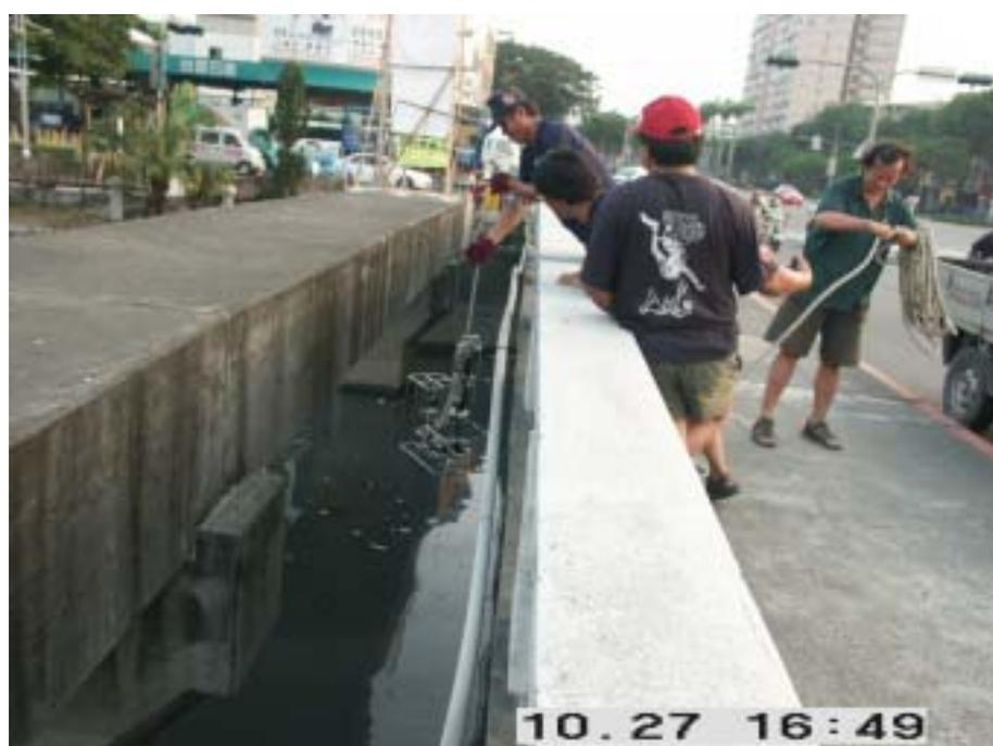
照片 3.4 由橋面垂放儀器觀測截流站上游河水水質情形
