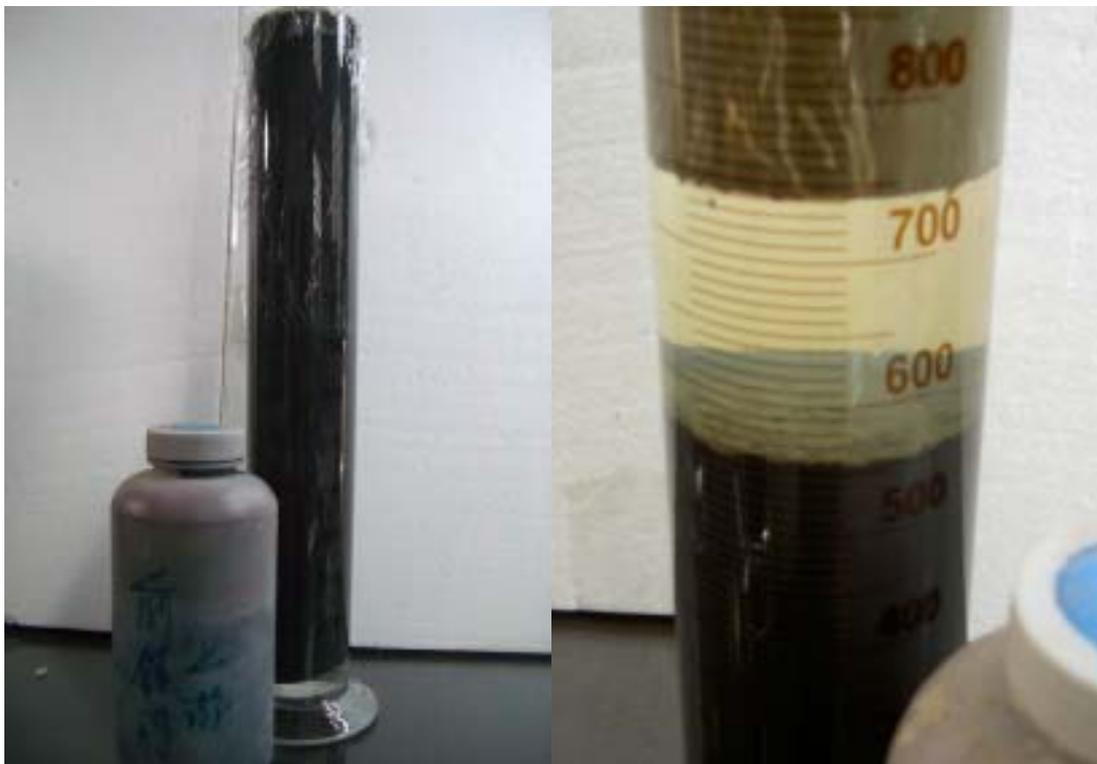
圖 7.25 前鎮河上游沈降實驗界面變化
