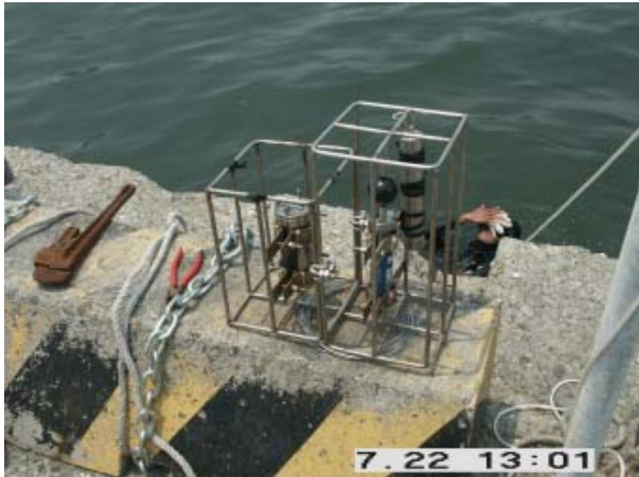
照片 3.19 安裝於二港口觀測站之海流儀、濁度計與水位計
