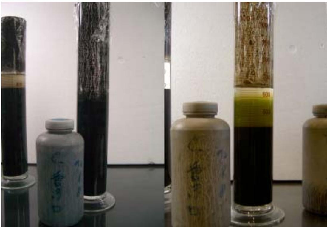
圖 7.7 C.愛河口沈降實驗界面變化
