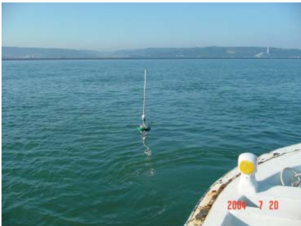
照片 7.5 台北港漂浮球流況觀測作業情形
