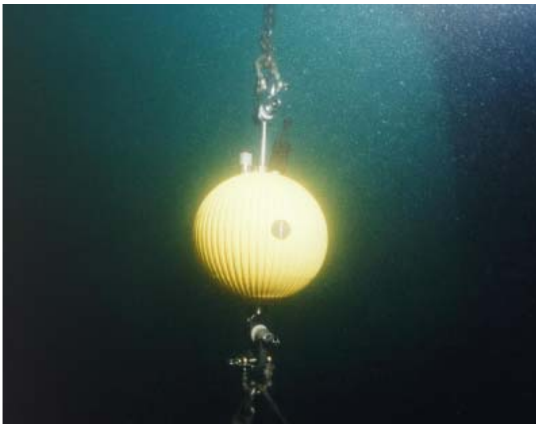
圖 3.1 台北港觀測樁現場水下 S-4ADW 潮波流儀
