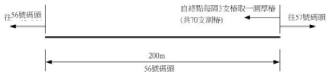
圖 4.14 高雄港 56 號碼頭鋼板樁厚度量測位置示意圖
