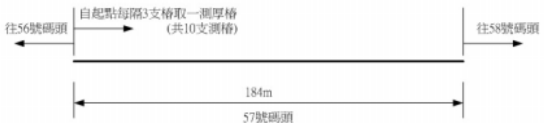
圖 4.20 高雄港 57 號碼頭鋼板樁厚度量測位置示意圖
