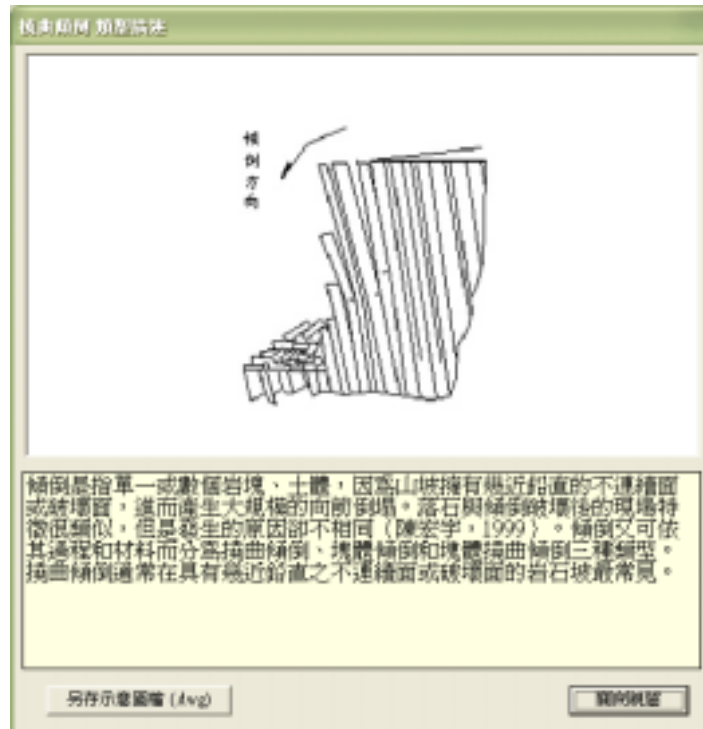
圖 3.12 岩石邊坡撓曲相關示意圖及類型描述界面
