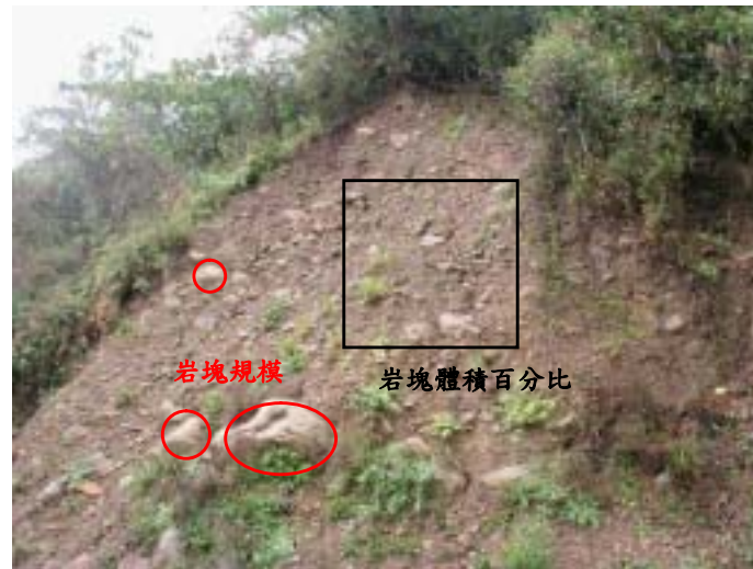
圖 4.6 風化及破碎程度示意圖
