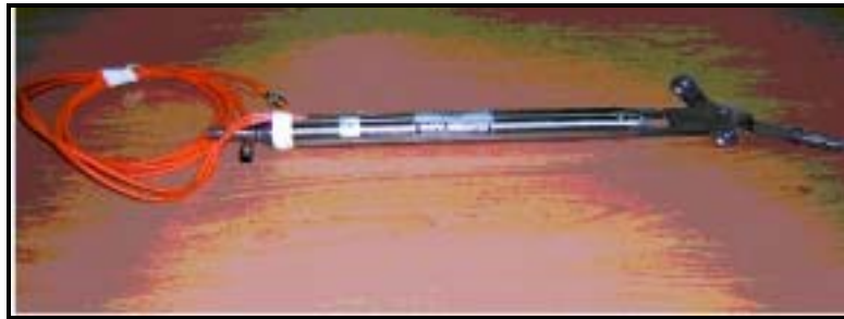
圖 5.47 孔內傾斜儀（單支）
