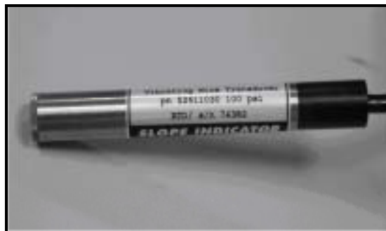
圖 5.48 振弦式水壓計
