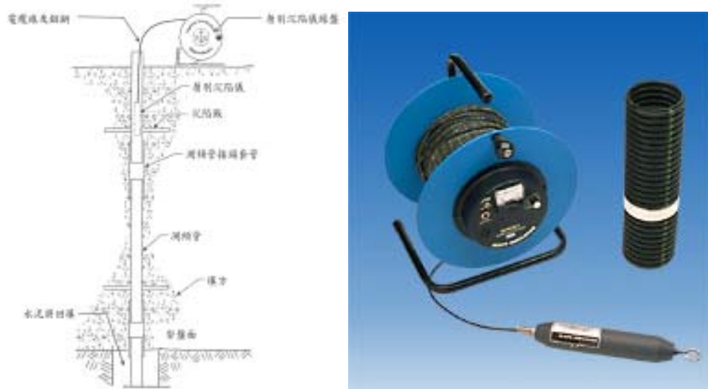
圖 5.18 磁感式連續沉陷計裝設示意圖以及量測沉陷使用之磁感器
