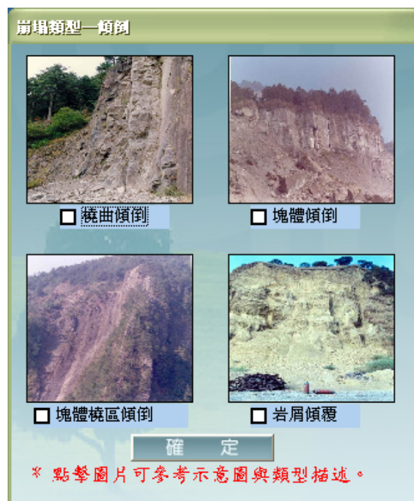
圖 3.11 岩石邊坡傾倒型態典型示意照片
