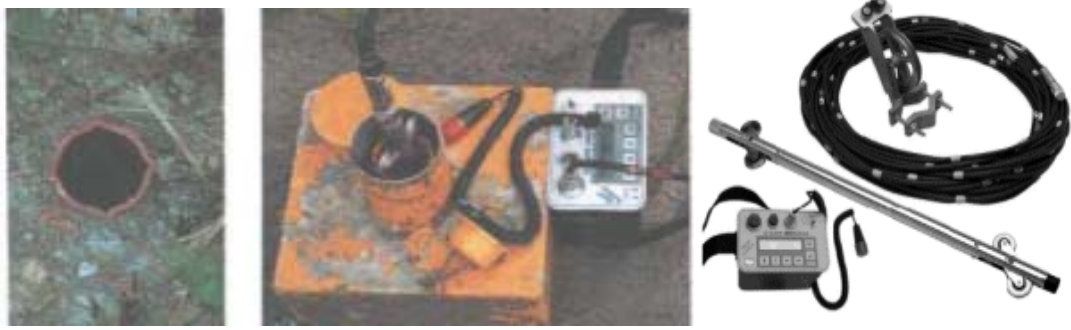
圖 5.9 傾斜觀測管、插入型傾斜觀測儀（計讀不同深度之地中傾斜並藉以推算水平位移量）以及資料擷取系統
