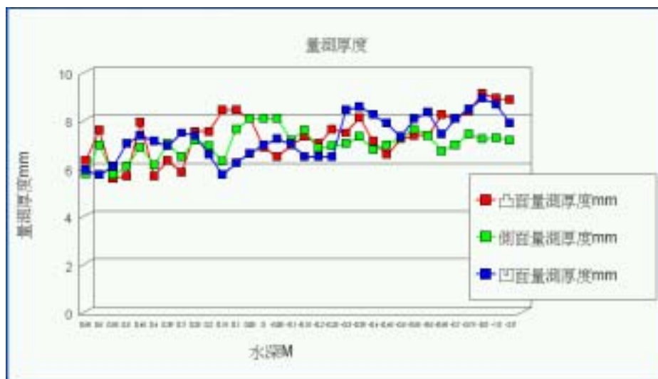
圖 3.10 蘇澳港鋼板凸側凹三面厚度比較圖
