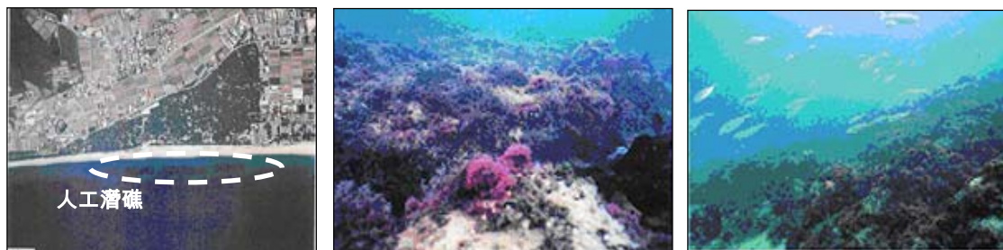
照片 4-7 慶野松原海岸之生態型人工潛礁
