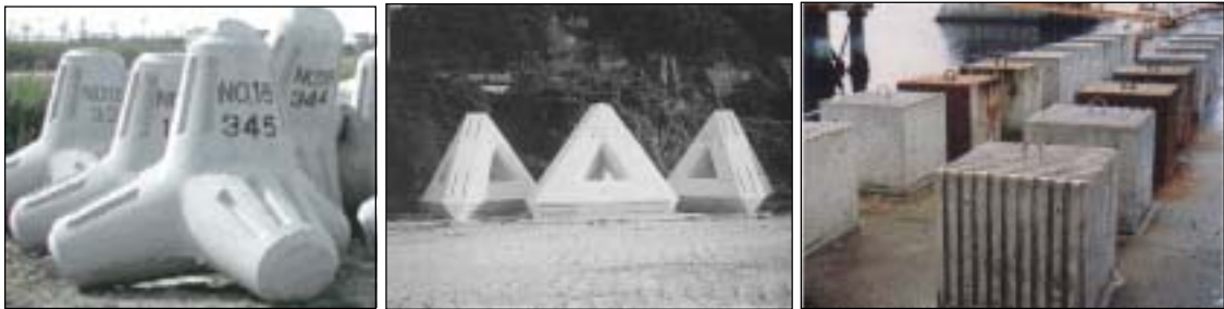
照片 4-2 表面凹凸處理之消波塊與方塊
