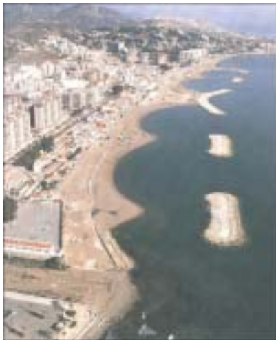
(A)結合離岸堤、岬頭及人工養灘 (B)結合 T 型突堤、緩傾斜護岸及人工養灘
