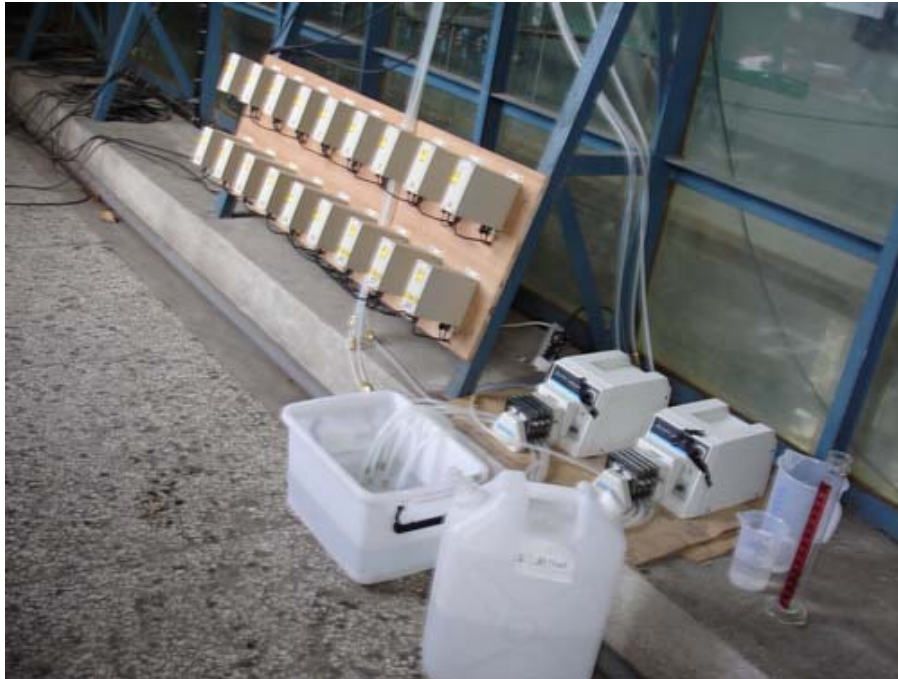
照片 6-1 蠕動泵浦及導電度計轉換器等試驗設備
