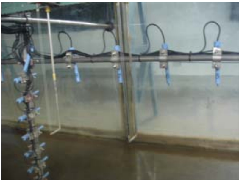
照片 6-6 試驗水槽內導電度計佈置情形
