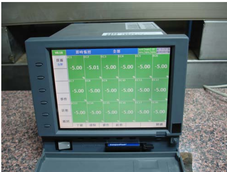
照片 6-2 導電度計資料擷取系統
