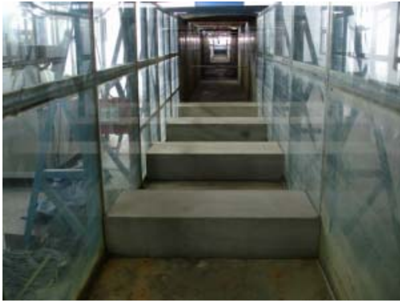
照片 6-5 試驗水槽內系列潛堤佈置情形
