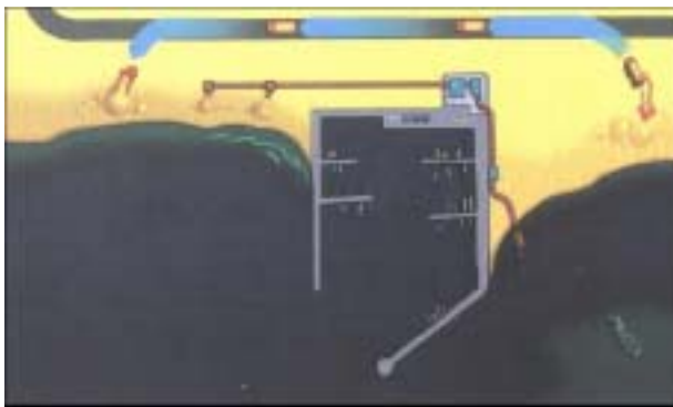
圖 2.11 土砂側渡法示意圖
