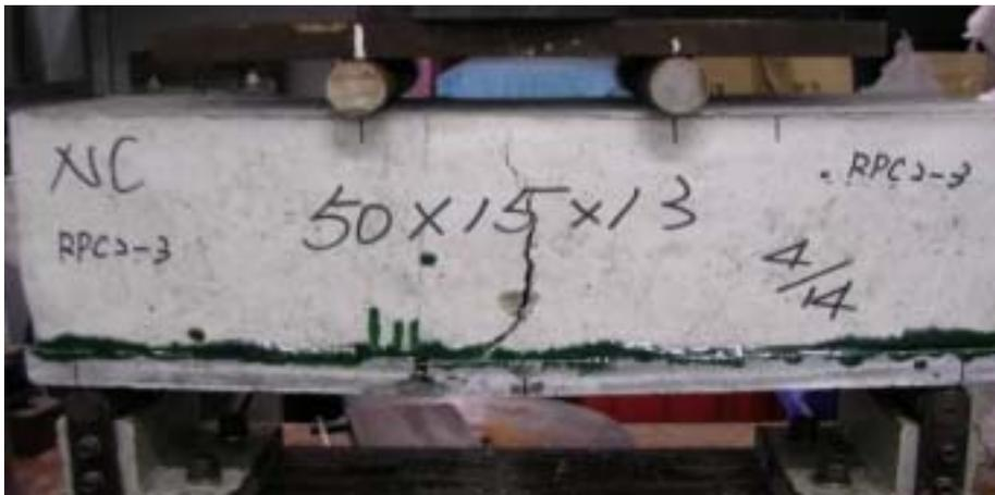
相片 5-22 RPC 補強 20 mm 之混凝土抗彎試驗結果 (RPC #14)
