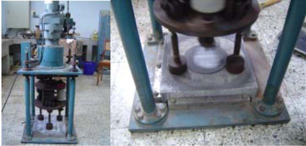
照片 4-24 表面磨耗試驗儀
