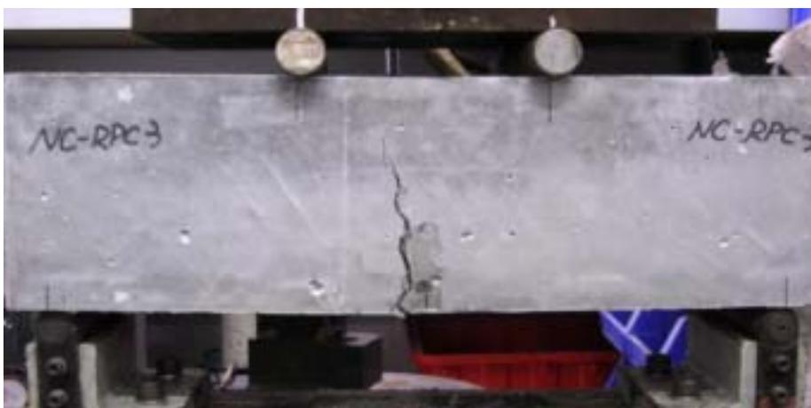
相片 5-23 RPC 包裹 U 型補強之混凝土抗彎試驗結果 (RPC #14)
