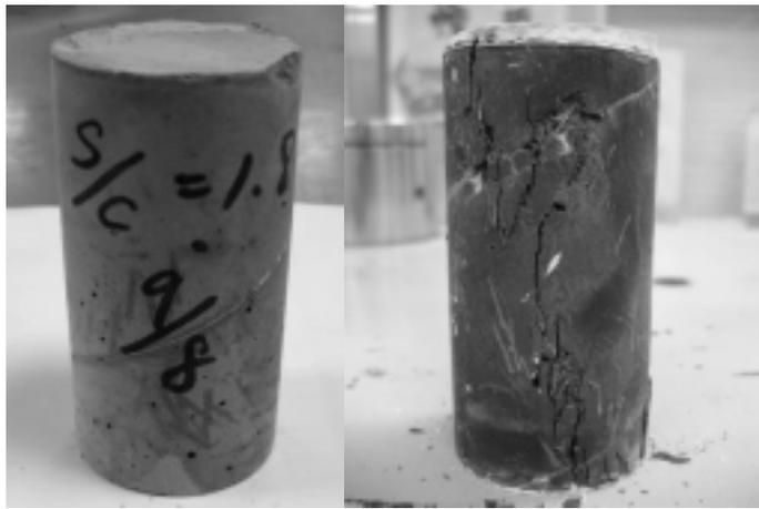
相片 5-1 典型 RPC #14 試體抗壓試驗破壞前後相片
