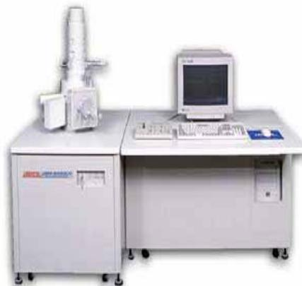
照片 4-26 掃瞄式電子顯微鏡
