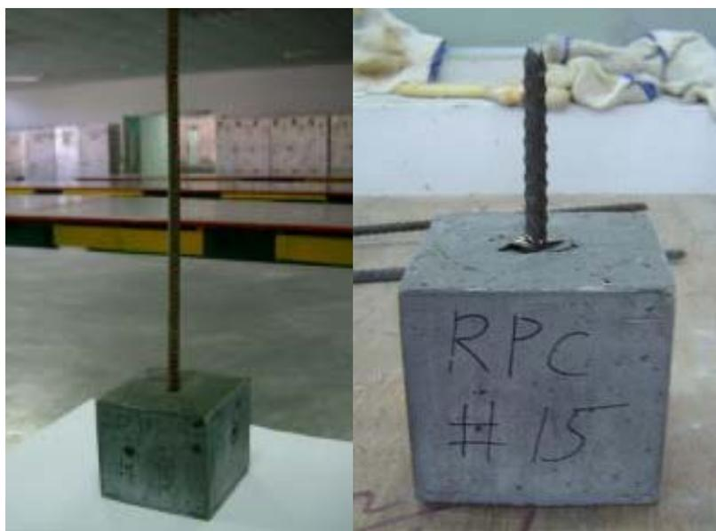
相片 5-4 典型 RPC 試體拉拔試驗破壞前後相片
