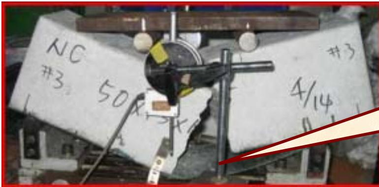
經CFRP補強後之試體，皆為CFRP拉脫及混凝土斷裂脫落，脆性破壞
