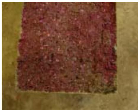
照片二 一般水泥砂漿(mortar)
