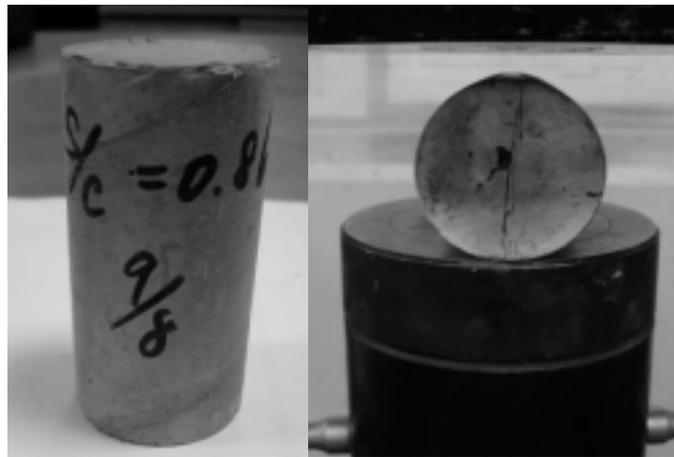
相片 5-2 典型 RPC #13 試體劈裂試驗破壞前後相片
