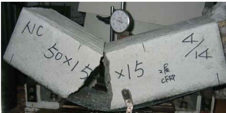
相片 5-26 CFRP 補強二層之混凝土抗彎試驗結果
