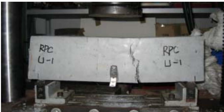
相片 5-29 RPC #15 包裹 U 型補強之混凝土抗彎試驗結果
