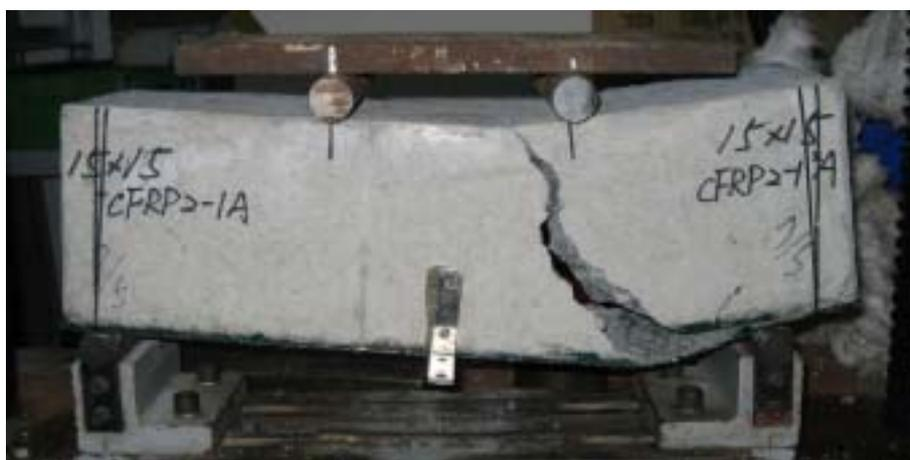
相片 5-32 CFRP 補強二層之混凝土抗彎試驗
