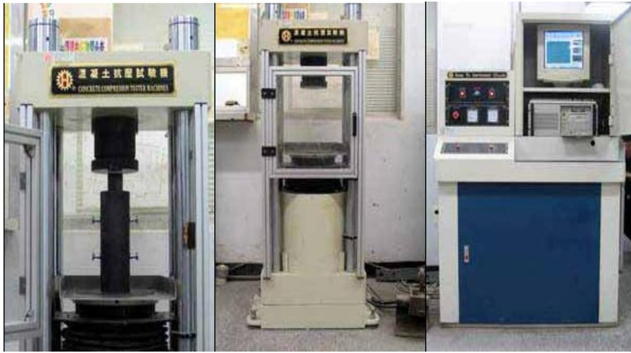
照片 4-17 200T 電腦式自動抗壓試驗機
