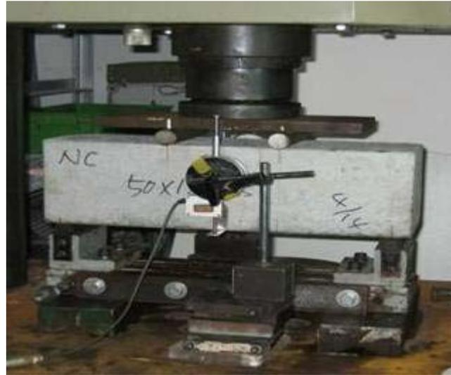
破裂面在中心點L/3處，抗彎強度
