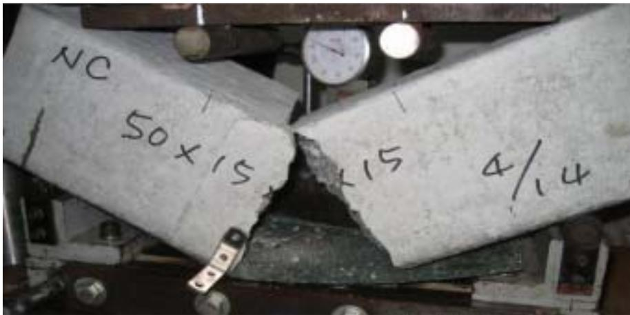
相片 5-25 CFRP 補強一層之混凝土抗彎試驗結果
