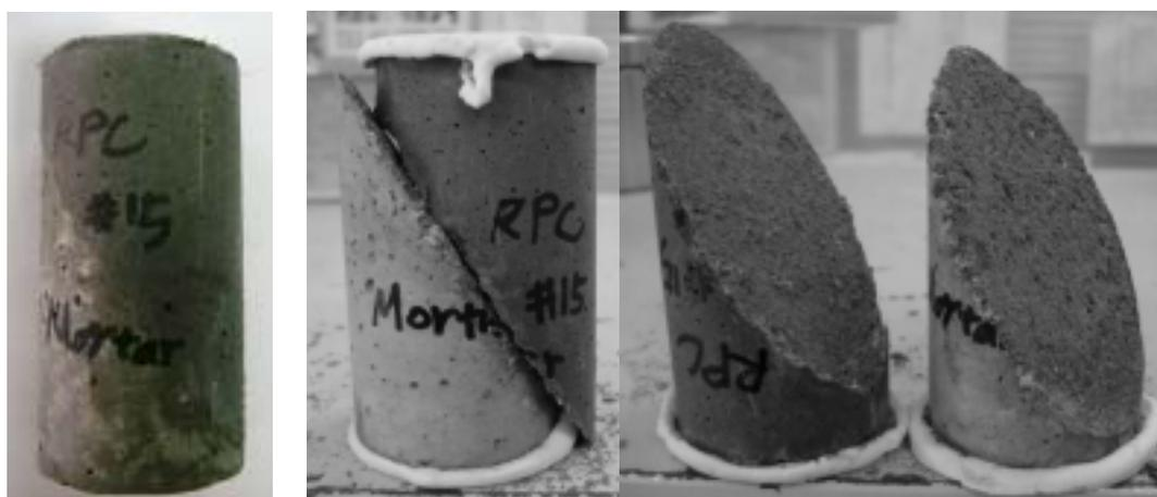
相片 5-5 典型 RPC 試體斜剪試驗破壞前後相片
