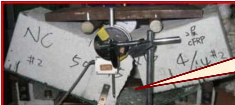
經CFRP補強後之試體，皆為CFRP拉脫及混凝土斷裂脫落，脆性破壞
