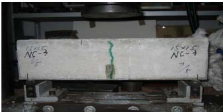
相片 5-30 未補強之普通混凝土抗彎試驗結果
