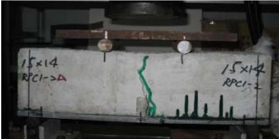
相片 5-27 RPC #15 補強 10 mm 之混凝土抗彎試驗結果
