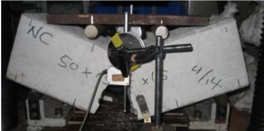
相片 5-24 未補強之普通混凝土抗彎試驗結果
