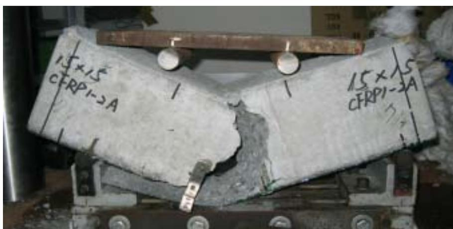
相片 5-31 CFRP 補強一層之混凝土抗彎試驗結果
