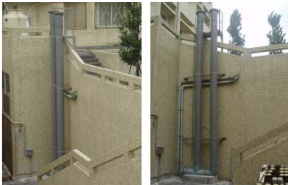
照片 2.1 容量式波高計與壓力式波高計的率定筒
