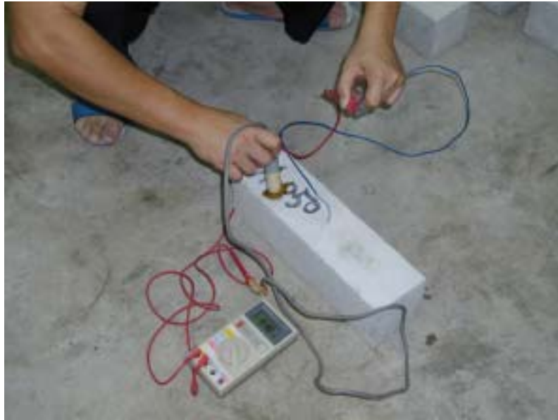
照片 4.9 鋼筋腐蝕電位值量測之情形
