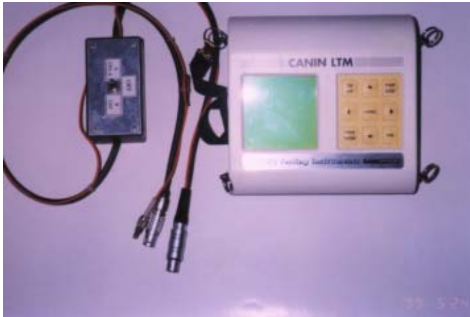
照片 4.6 Anode-Ladder-System 腐蝕監視系統
