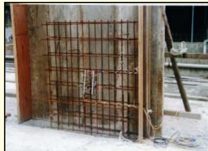
試驗牆內 Sensor 埋設情形
