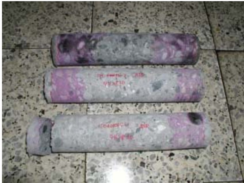
照片 4.10 中性化較為嚴重的 OPC 混凝土試體
