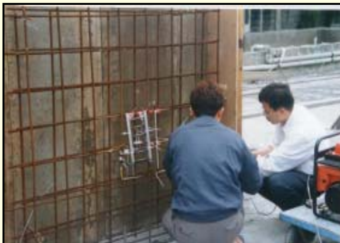
試驗牆內 Sensor 埋設情形
