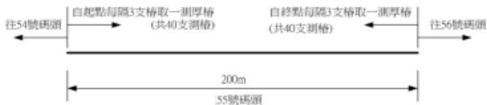
圖 3.11 高雄港 55 號碼頭鋼板樁厚度量測位置示意圖
