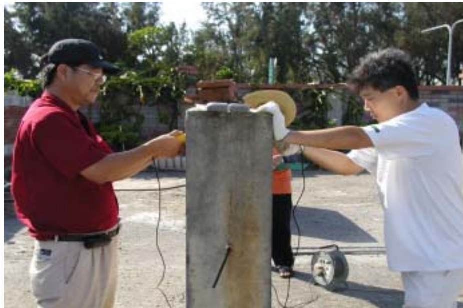
照片 4.2 現地混凝土試驗牆超音波量測
