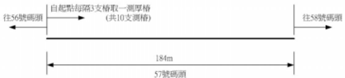
圖 3.23 高雄港 57 號碼頭鋼板樁厚度量測位置示意圖
