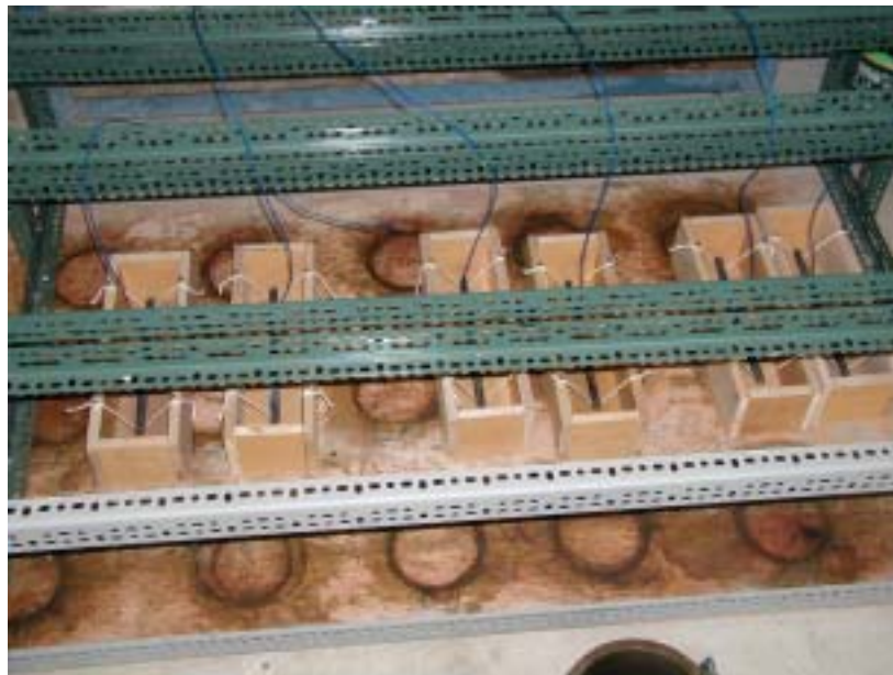
照片 4.8 鋼筋腐蝕電位量測之試體灌製前之情形
