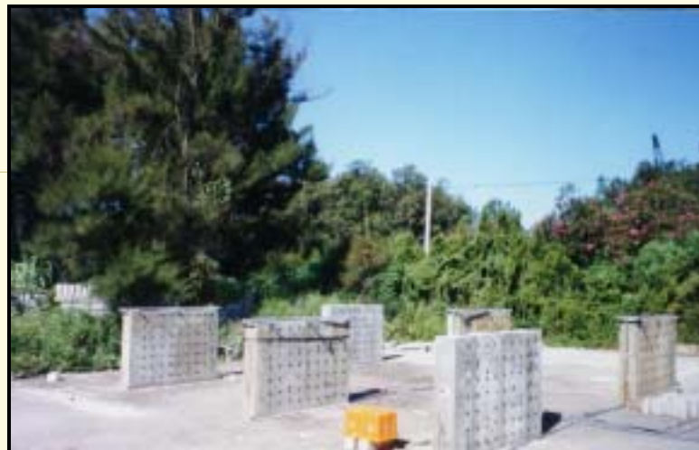
混凝土試驗牆暴露位置現場配置圖
