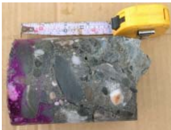
照片 4.14 鑽心試體中性化程度量測情形
