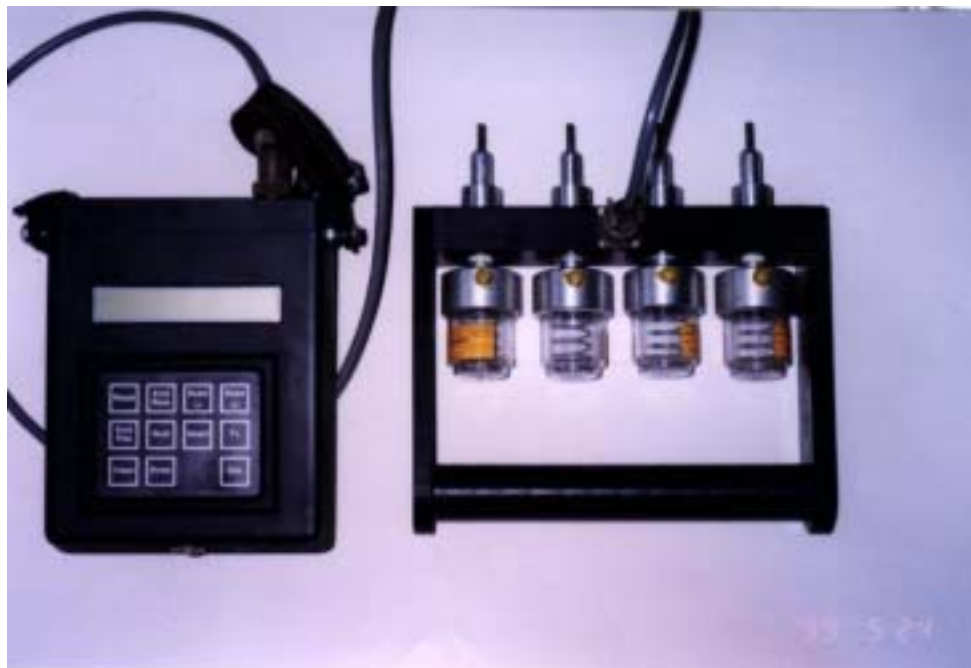
照片 3.3 混凝土電阻係數量測儀
