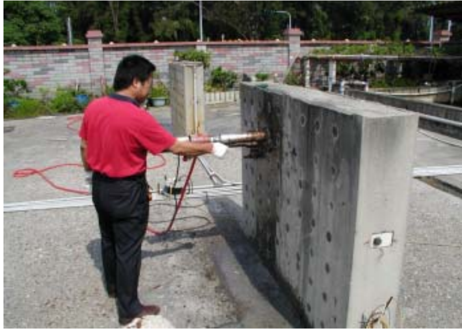
照片 3.1 混凝土試驗牆鑽心試驗
