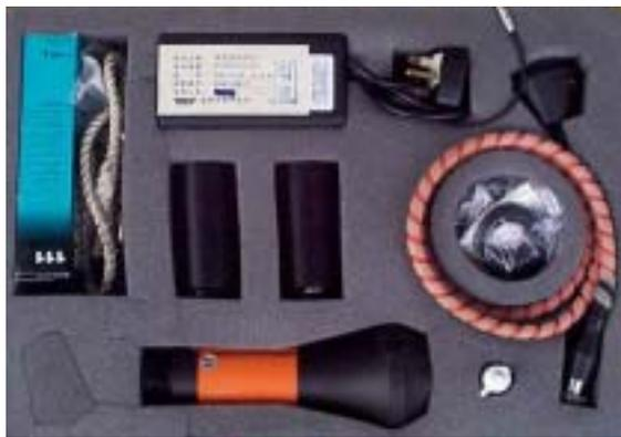
A-scan 超音波測厚計-單點量測
