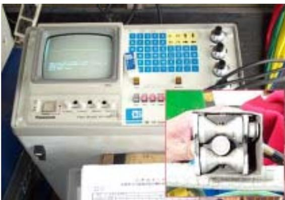
B-scan 超音波測厚計-平面量測
