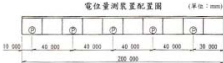
圖 2. 鋼管(板)樁犧牲陽極配置示意圖
