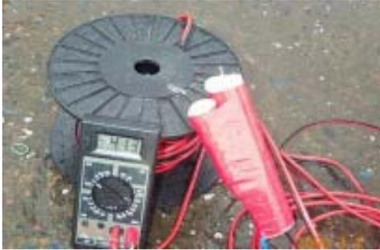
電位檢測儀器(氯化銀參考電極)
