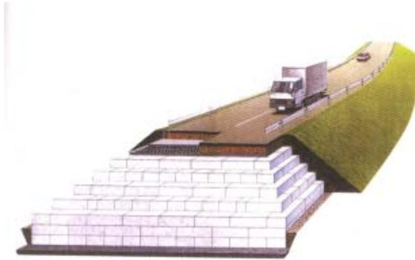
圖 3 路堤填築使用 EPS 示意圖
