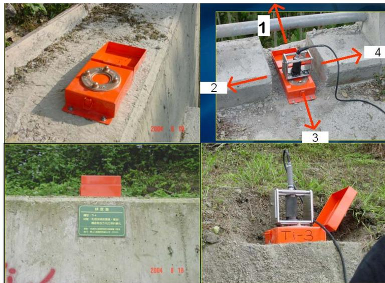
圖 1.7 傾度盤安裝於擋土結構上之方式
