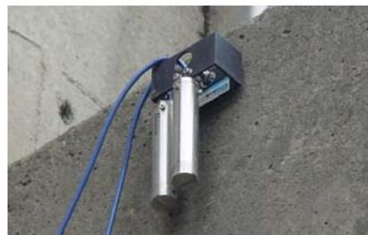
圖 3.8 自動監測傾斜計
