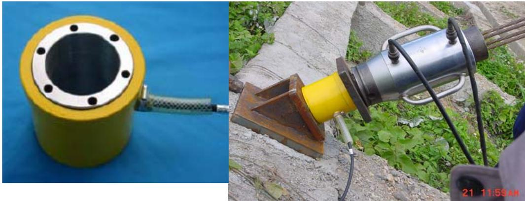
圖 1.9 地錨荷重計安裝設置情況
