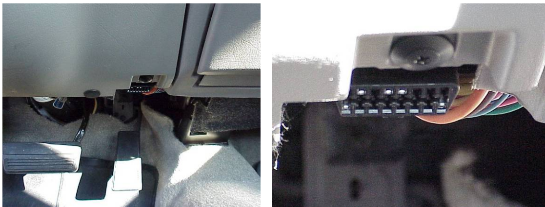
圖 5.19 Diagnostic Link Connector (DLC)
