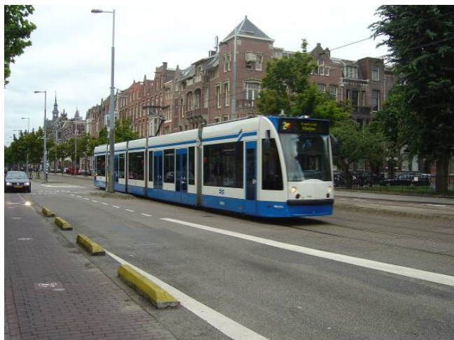
圖 3.3.10 荷蘭阿姆斯特丹以微凹的坡面將軌道與車道隔離(2)
