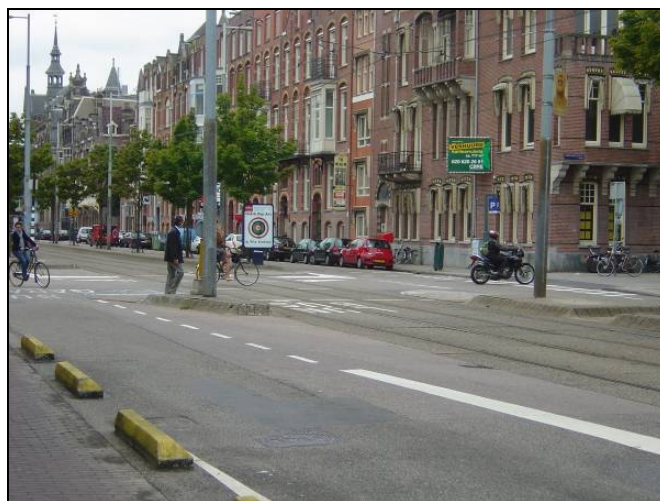
圖 3.3.9 荷蘭阿姆斯特丹以微凹的坡面將軌道與車道隔離(1)
