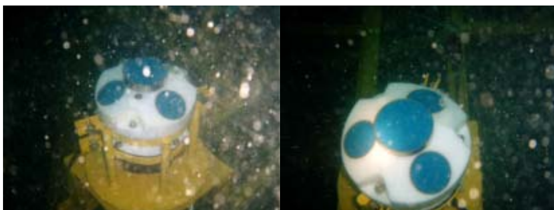
(左及右) AWCP 剖面流速波浪儀水下情形
