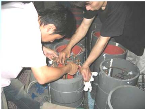
柱鋼筋在模板中組立
