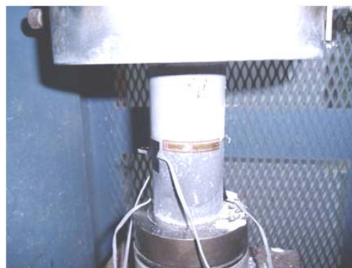
破壞後之柱試體
