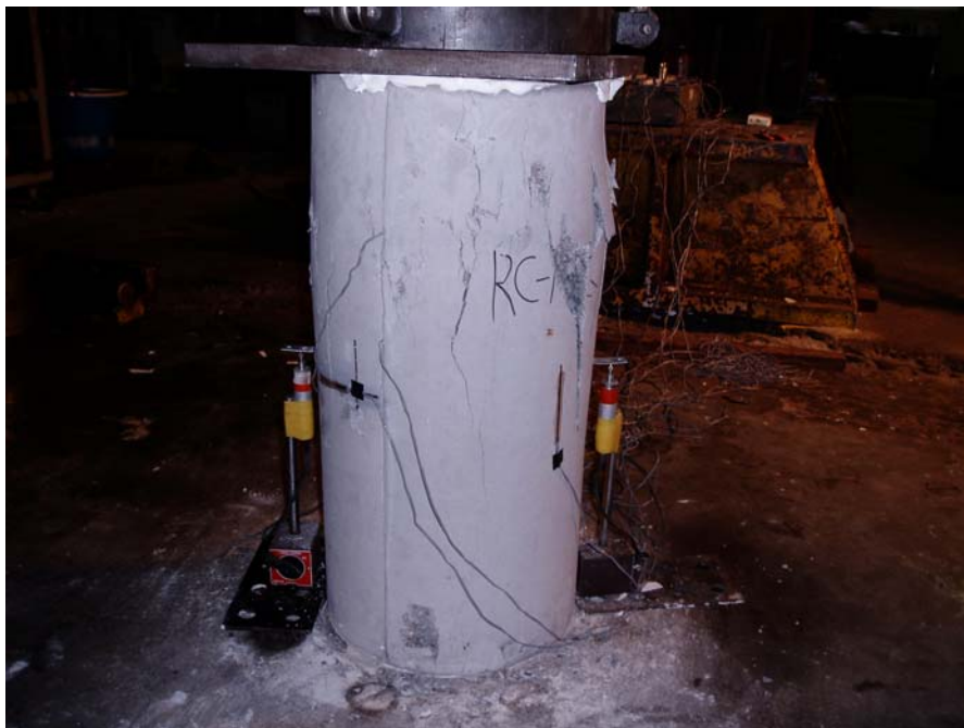
圖 6-4 控制組試體破壞外觀(1)
