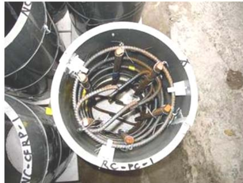
柱鋼筋在模板內組立完成
