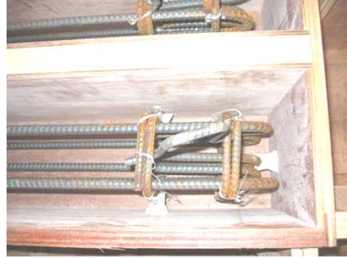
柱試體兩端箍筋補強
