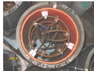
圖 2-4 灌製前縮小尺寸柱之模具 (RPC 補強)
