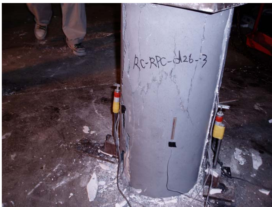
圖 6-25 RPC 補強組試體破壞外觀(2)
