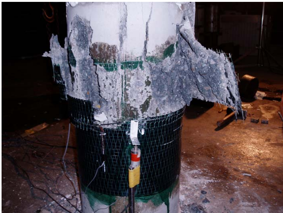
圖 6-16 CFRP 補強組試體破壞外觀(2)
