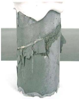
照片三 RPC 抗壓試驗後試體
