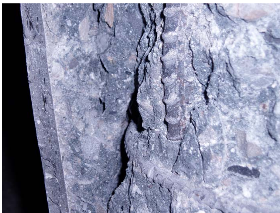
圖 6-26 RPC 補強組試體破壞後界面黏結情形
