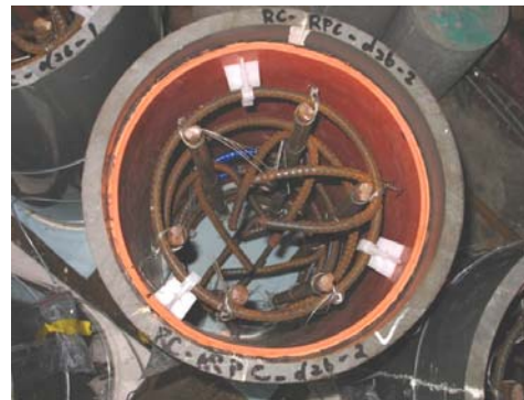
照片十 灌製前縮小尺寸柱之模具 (RPC 補強)
