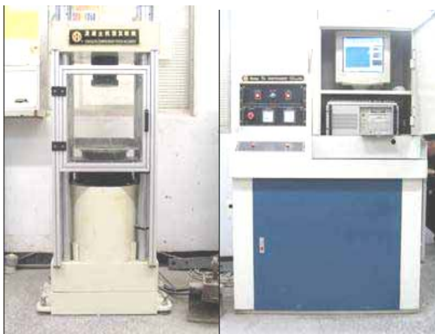
照片 5-15 200T 電腦式自動抗壓試驗機
