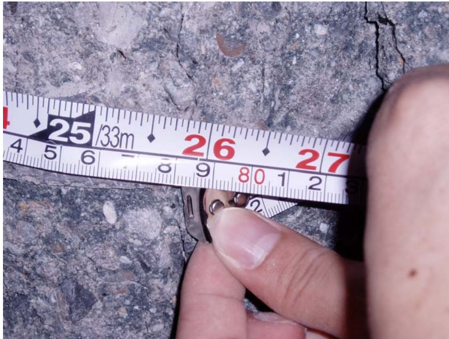
圖 6-7 控制組試體箍筋長度量測
