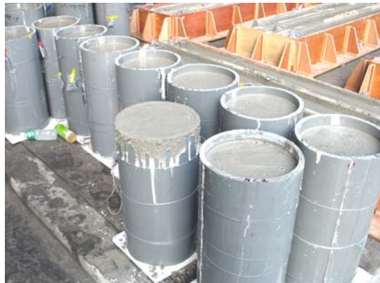
照片十四 灌製完成之縮小尺寸柱
