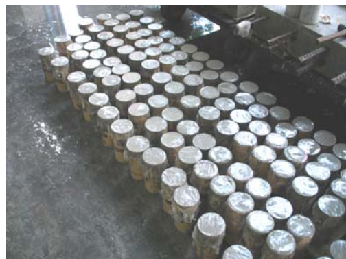
照片十二 灌製完成之圓柱試體
