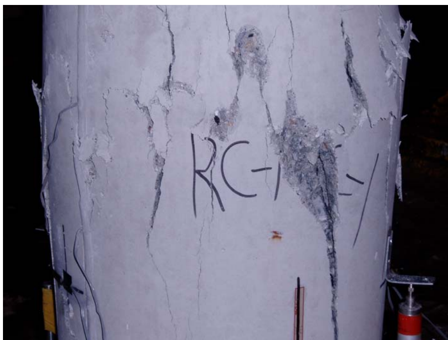
圖 6-5 控制組試體破壞外觀(2)
