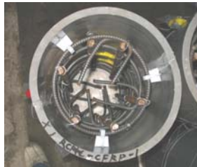
圖 2-3 灌製前縮小尺寸柱之模具 (CFRP 補強)
