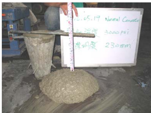
照片十一 混凝土坍度試驗 (坍度 230 mm)
