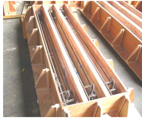
照片八 灌製前縮小尺寸梁之模具
