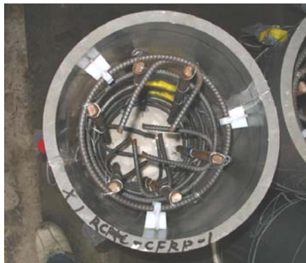
照片九 灌製前縮小尺寸柱之模具 (CFRP 補強)
