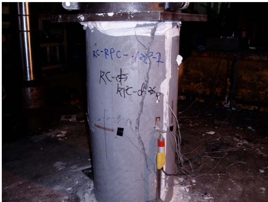
圖 6-24 RPC 補強組試體破壞外觀(1)
