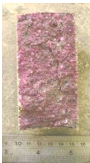
水泥砂漿 (碳化深度3.1mm)
