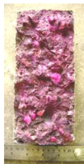
普通混凝土 (碳化深度1.2mm)
