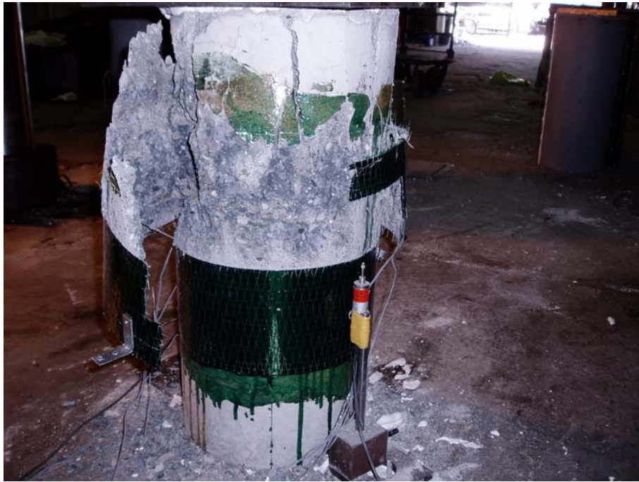
圖 6-15 CFRP 補強組試體破壞外觀(1)
