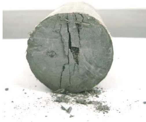
照片四 劈裂試驗後試體
