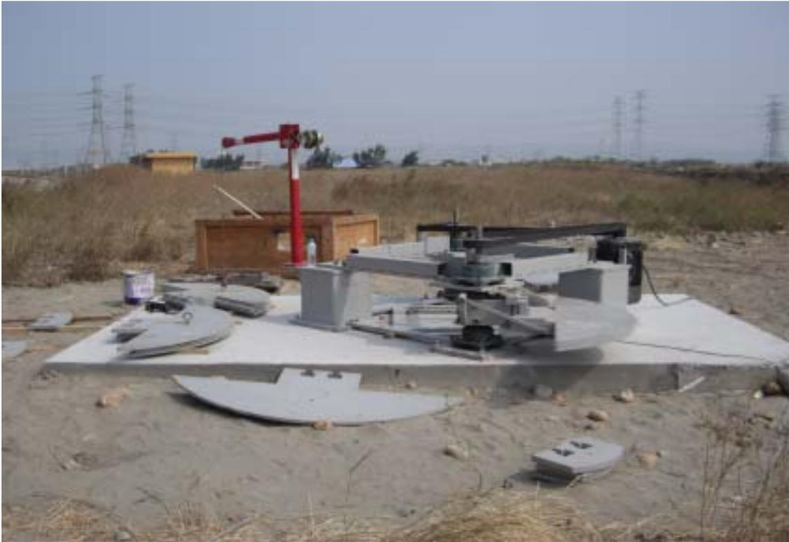
圖 7-1 偏心式動態震源圖(Eccentric Mass Vibrator)
