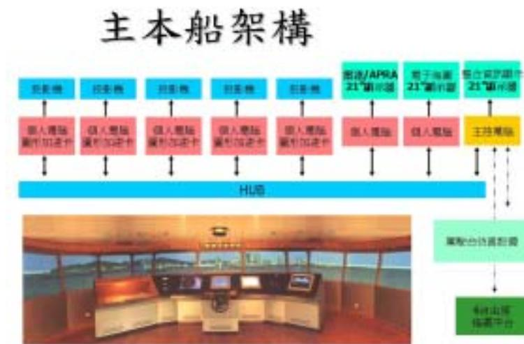
圖 3-1 多船模擬系統主本船硬體架構圖
