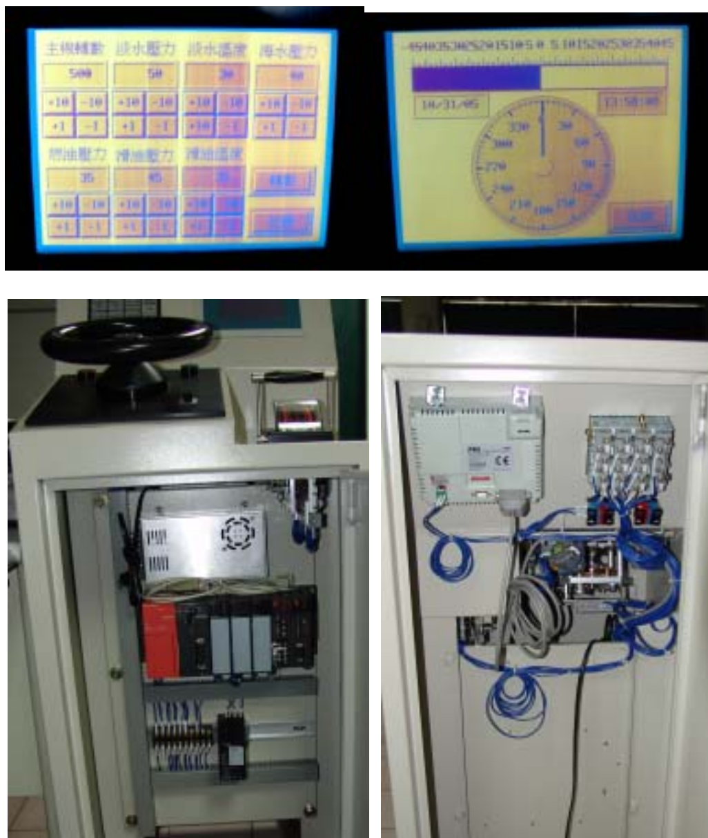
圖4-3 「船舶駕駛控制台」外觀(上、中)以及仿真設備連線情形(下)。
