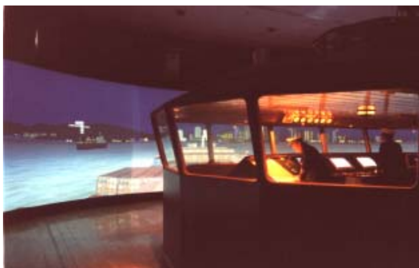
圖 1-4 使用多個曲面投影機將海景視效投射於圓柱螢幕上，建構出大型海港的模擬場景
