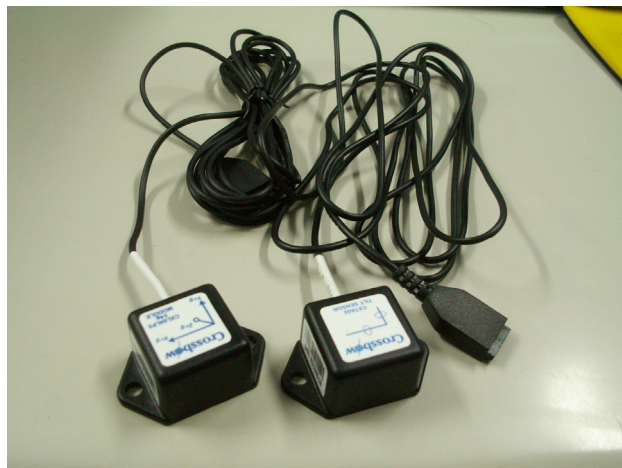
圖 4-5 Crossbow 加速度計及傾角計等感測器
